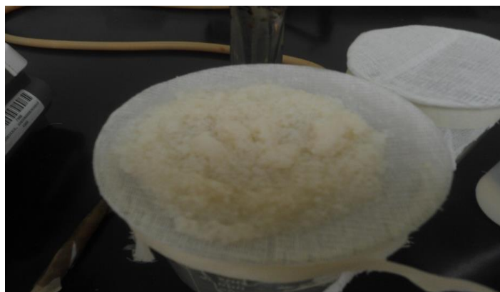
Figura 7. Filtración y lavado de las microcápsulas en condiciones asépticas.
