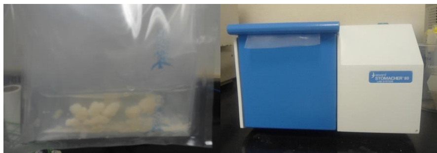
Figura 8. Homogenización de las microcápsulas
