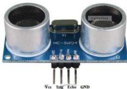
Figura 3.7a: Sensor ultrasónico HC-SR04
