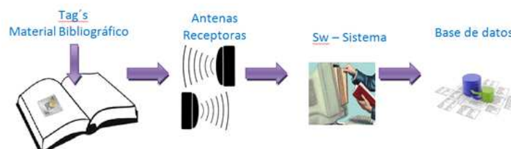
Figura 4.1: Diagrama a bloques del sistema
