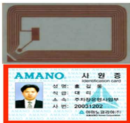
Figura 2.5: Ejemplo de cobertura de un tag RFID
