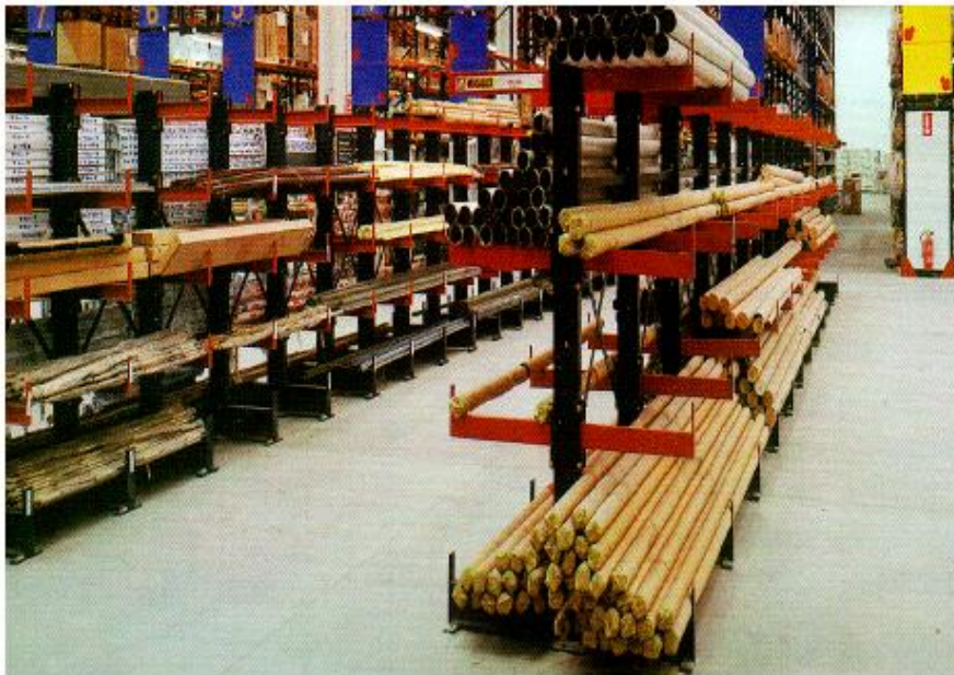
Imagen 3-5: Estructura para el almacenamiento de cargas largas.
