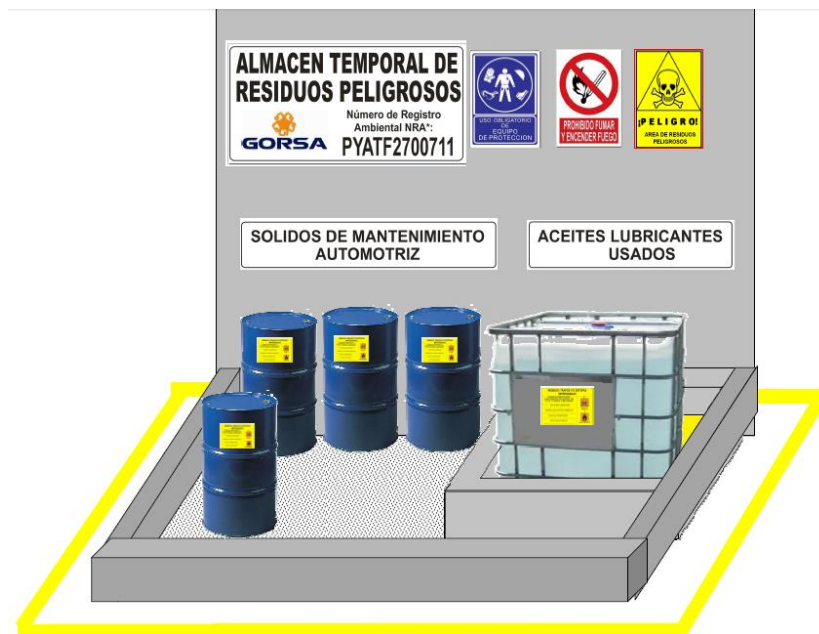
Figura 6.2. Diseño interior del almacén temporal de residuos peligrosos
