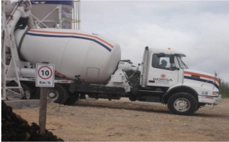
Fotografía 2.2 Camión de transporte de concreto premezclado capacidad 7\text{m}^3 .
