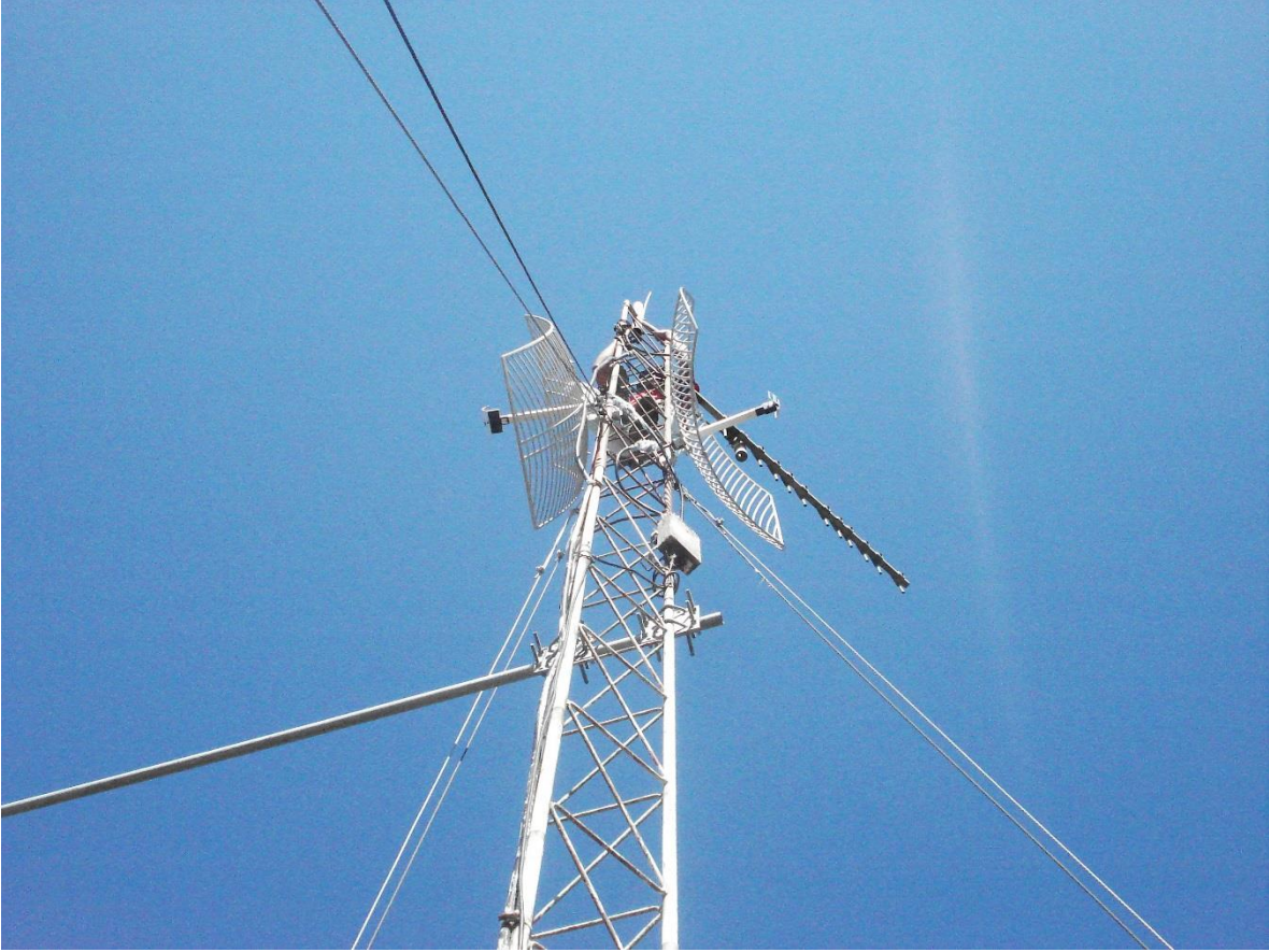
Fig. 20 Enlace inalámbrico de espectro disperso colocado en los distintos puntos.
