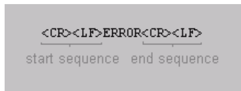
Figure 4: Comando AT Respuesta Incorrecta
