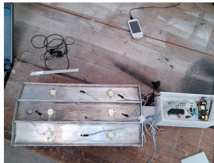
Figura 44: Instalación de la interfaz electrónica en la lámpara
