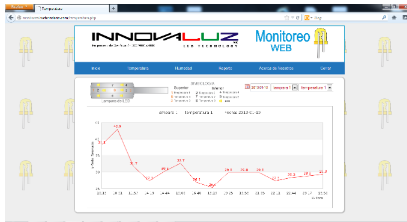
Figura 38: Grafica individual del sensor LM35 fecha 10/01/2013
