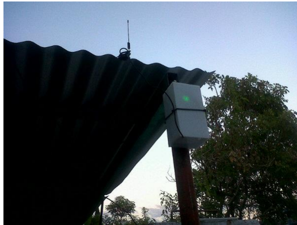
Figura 33: Prototipo en su contenedor durante las pruebas de 72 hrs
