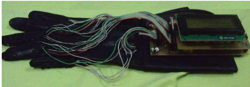
Figura 8.6 Guante con sensores para reproducir el sonido de las letras
