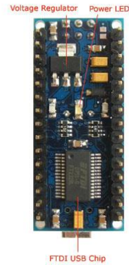
Figura 9.4 Arduino Nano características 2
