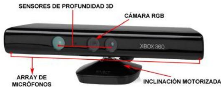
Figura 8: Componentes del Sensor Kinect
