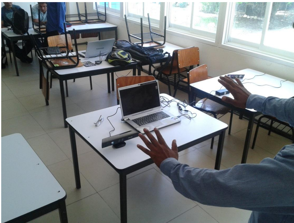
Figura 33: Kinect interpretando los gestos del usuario
