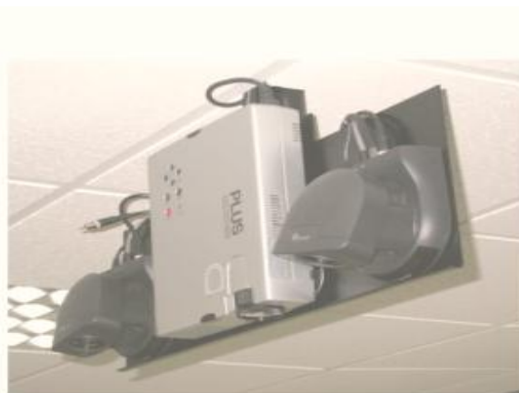
Figura 2: Posición de las cámaras y el proyector para la utilización horizontal
