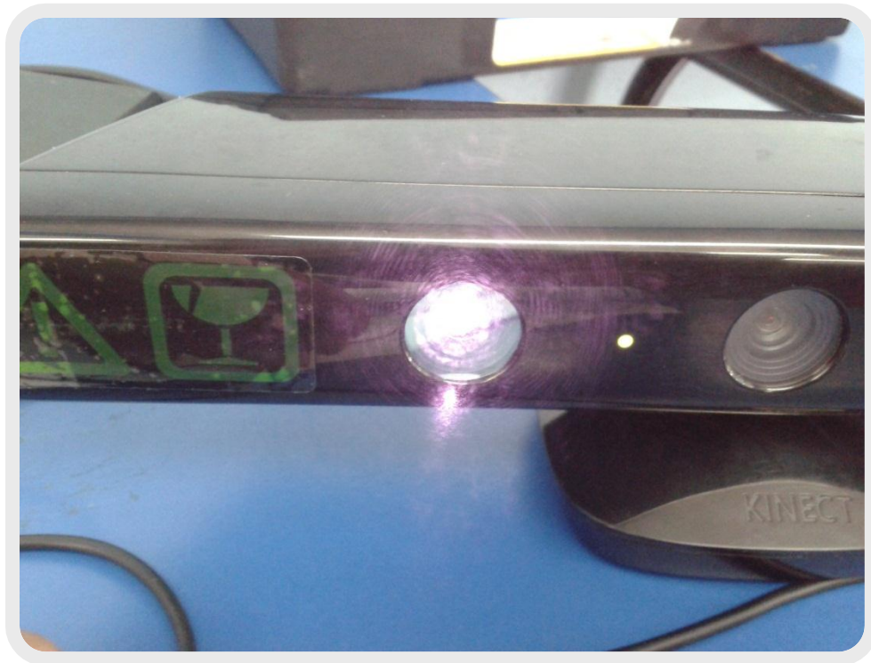
Figura 12: Sensor de profundidad (infrarrojos) en funcionamiento
