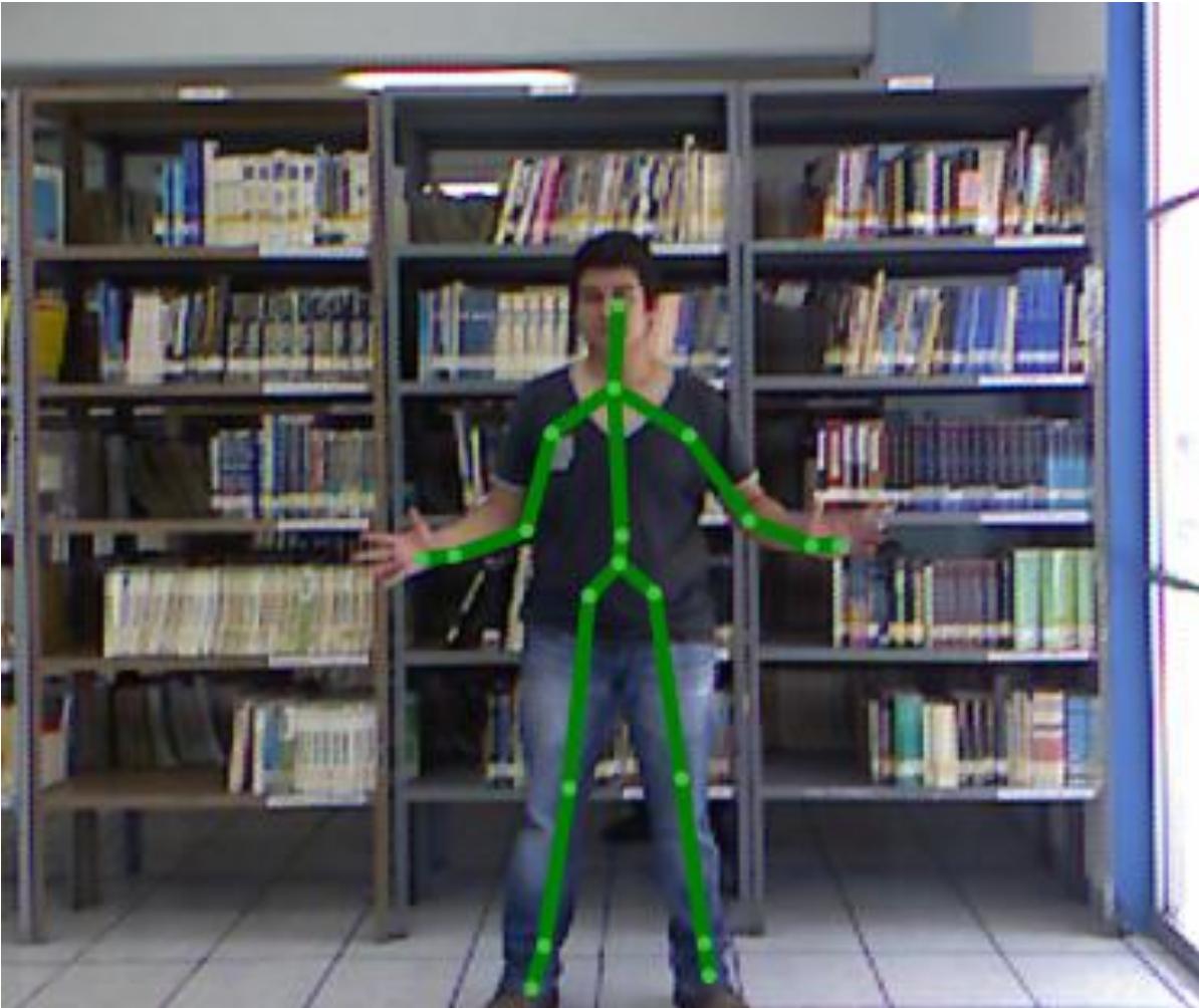
Figura 21. Esqueleton completo de una persona, obtenido con el Kinect
