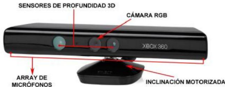
Figura 35: Componentes del sensor Kinect
