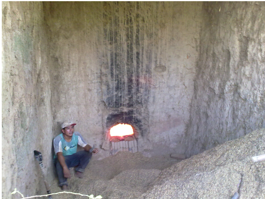
Fig.3.6 Personal encargado de la alimentación de combustible del horno rudimentario
