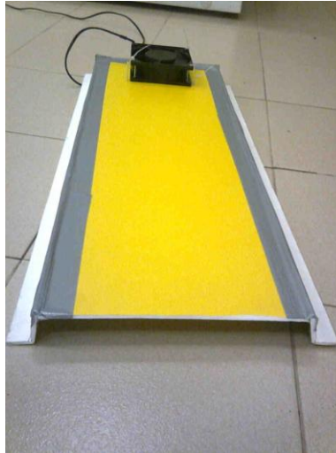
Figura 3.25. Ducto y ventilador acoplados
