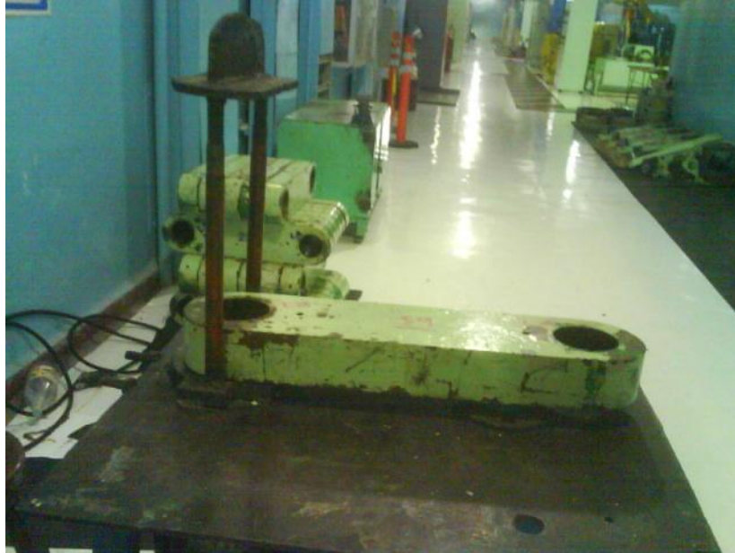
Figura 63.- Extracción de bujes en eslabones.
