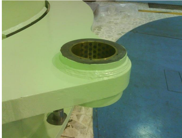
Figura 83.- anillo de regulacion reparado con bujes nuevos.
