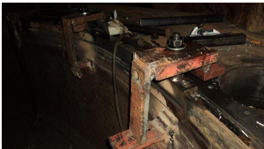
Figura 52.- Dispositivo para retirar placas de desgaste del escudo inferior.
