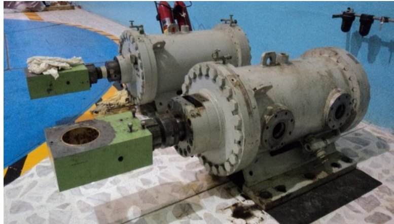
Figura 35.- Servomotores que mueven el anillo de regulación
