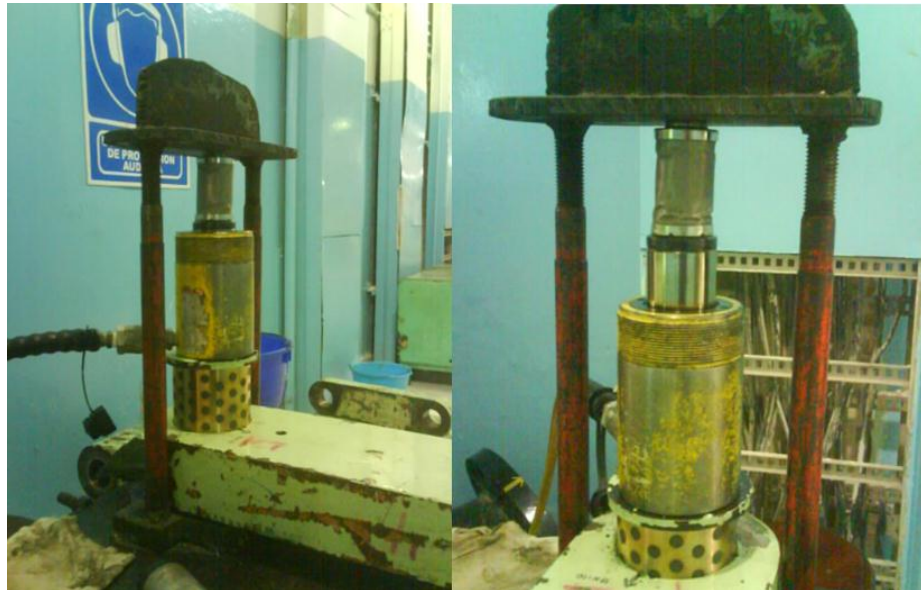
Figura 66.- Montaje de bujes de bronce nuevos en eslabones.
