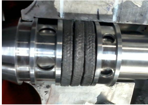
Fig.92 Empaquetadura de prensaestopas
