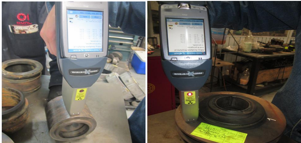
Fig.72 Análisis químico (metalográfico) con rayo laser
