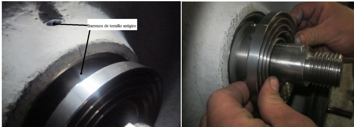
Fig.122 ajuste de laberinto estático
