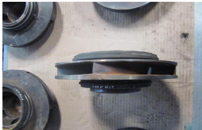
Fig.70 Inspección visual a impulsores
