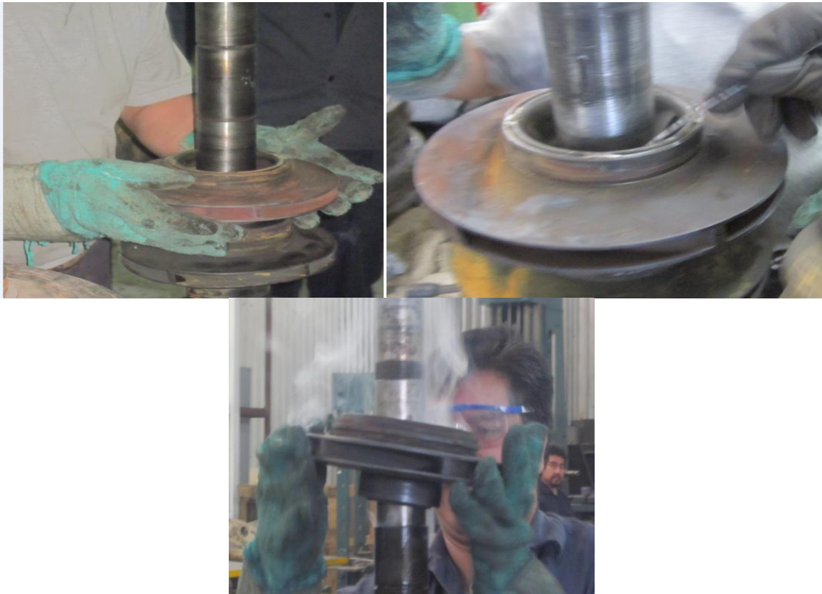
Fig.66 Extracción de cuñas, candados e impulsor
