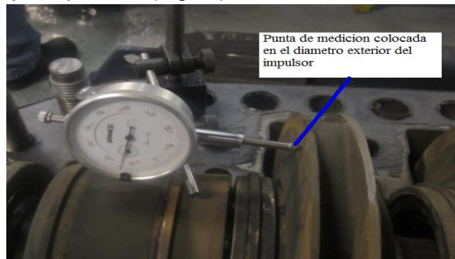
Fig.42 Posición correcta del comparador
