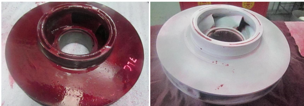
Fig.71 Líquido penetrantes a impulsores
