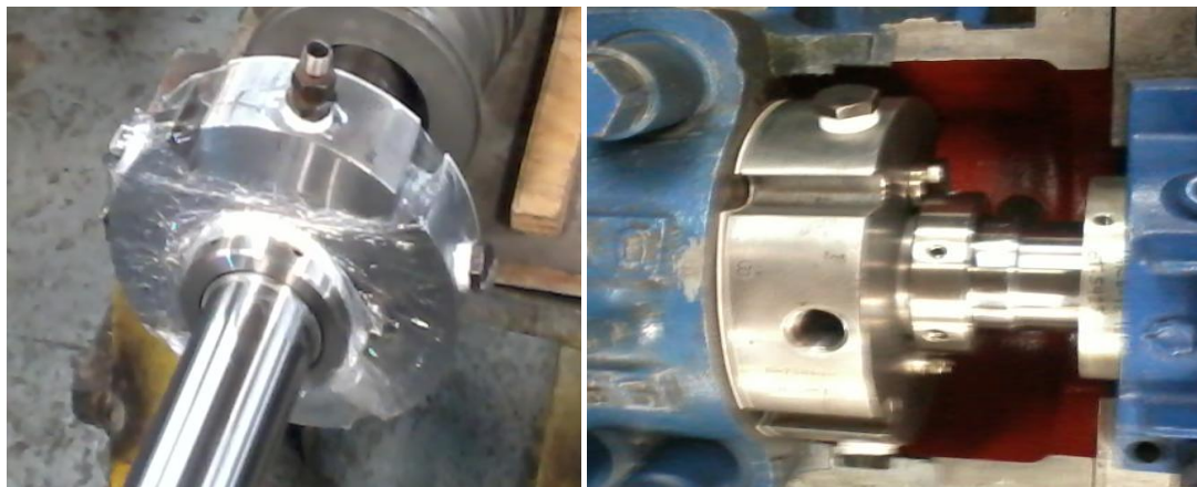
Fig.89 Ajuste y posición de sello mecánico
