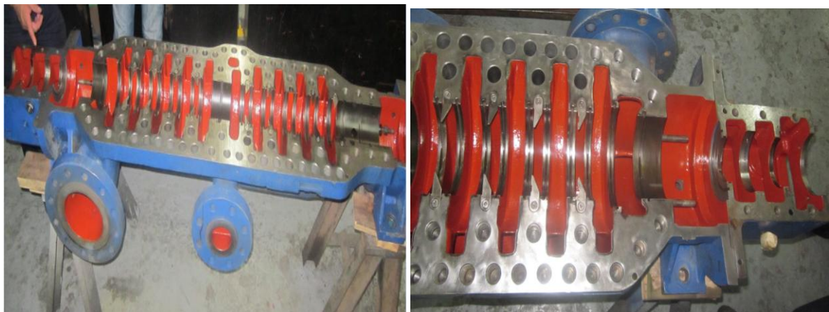
Fig.77 Aplicación de pintura de impregnación
