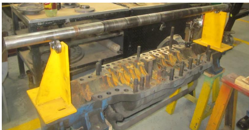
Fig.69 Prueba de deflexión del eje
