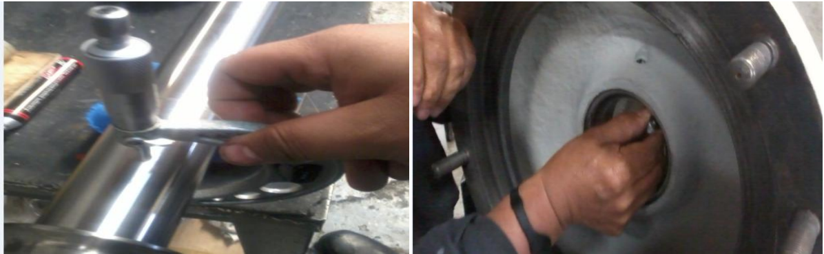
Fig.118 Mediciones de diámetro de eje y chumaceras
