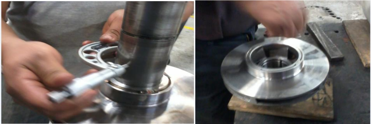
Fig.78 Medición ajuste de diámetros
