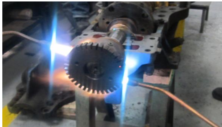
Fig.55 Calentamiento del acople
