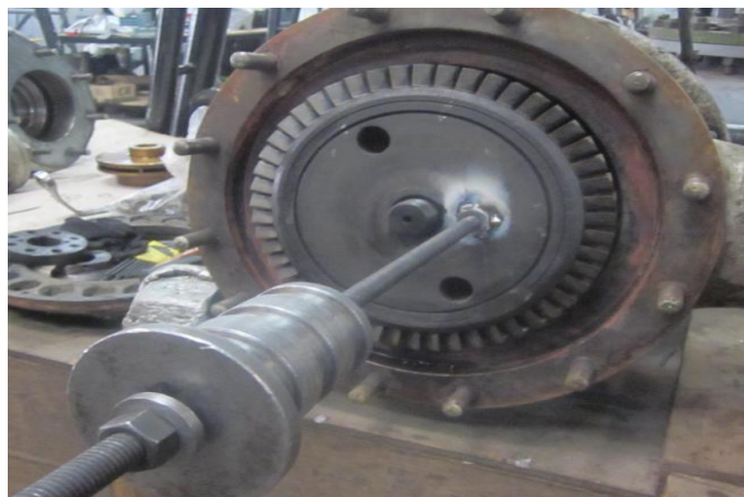
Fig.106 Extracción de alabes
