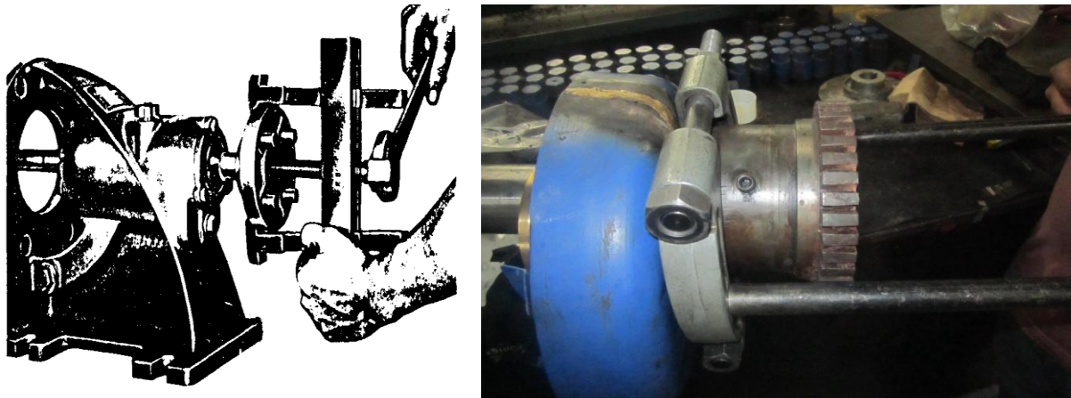
Fig.54 Extracción de acoplamiento
