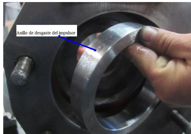
Fig.105 Extracción de anillo de desgaste
