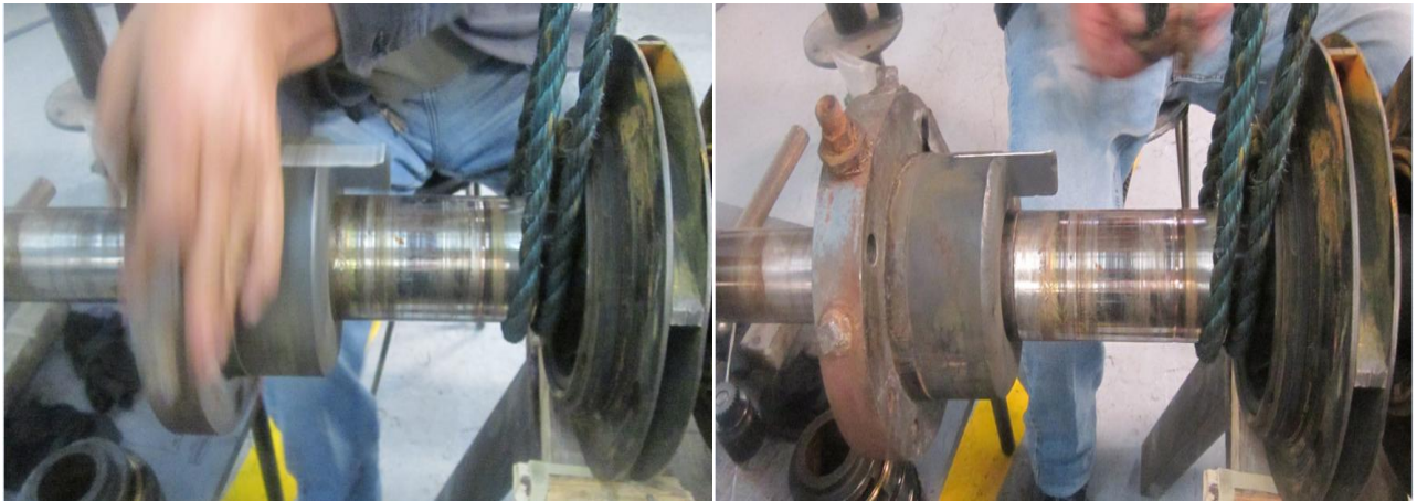
Fig. 56 Desmontaje de sellos mecánicos o prensa estopas
