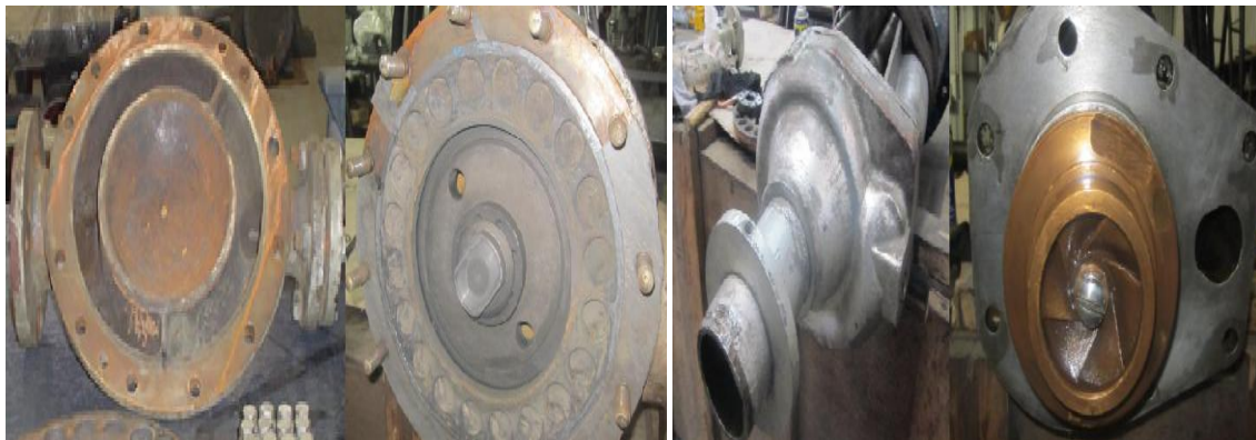
Fig.101 Desmontaje de carcasa lado turbina y lado bomba
