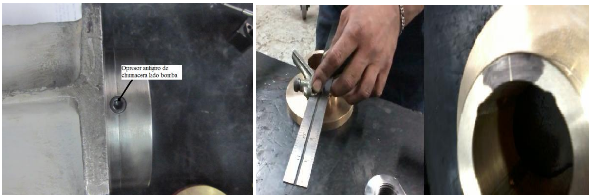
Fig.117 Centrado de barreno anti-giro
