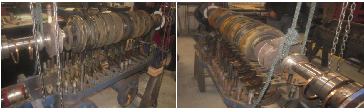
Fig.50 Desmontaje del rotor
