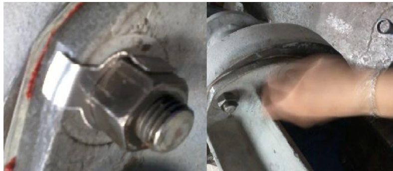
Fig.128 ajuste de tornillería en carcasa
