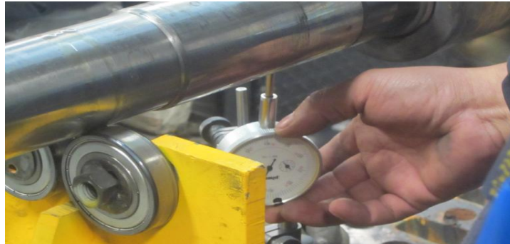
Fig.68 Posición del comparador
