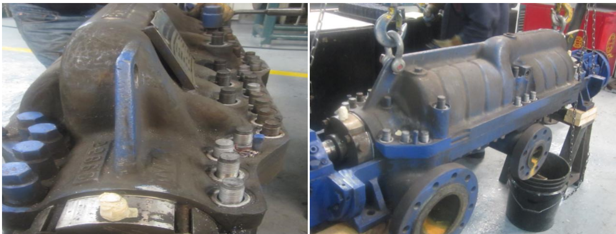
Fig.38 Desmontaje de tuercas
