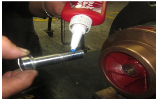
Fig.121 Ajuste de tornillo de impulsor
