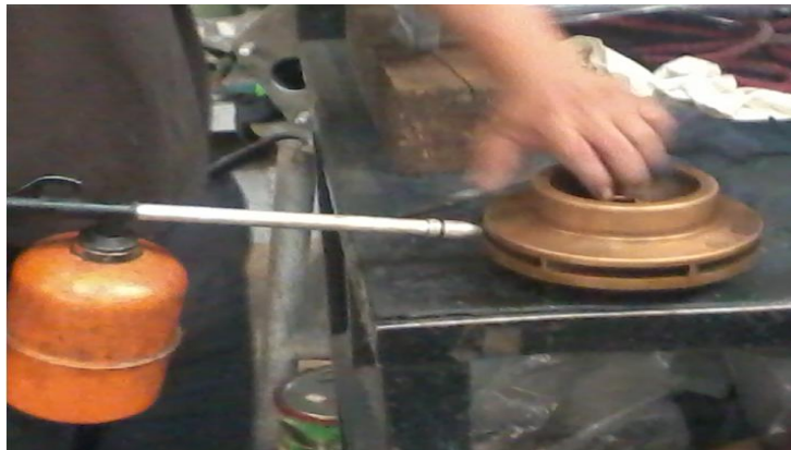
Fig.74 Limpieza pulverización baja presión
