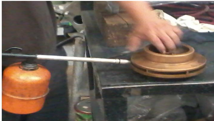
Fig.112 Limpieza pulverización baja presión
