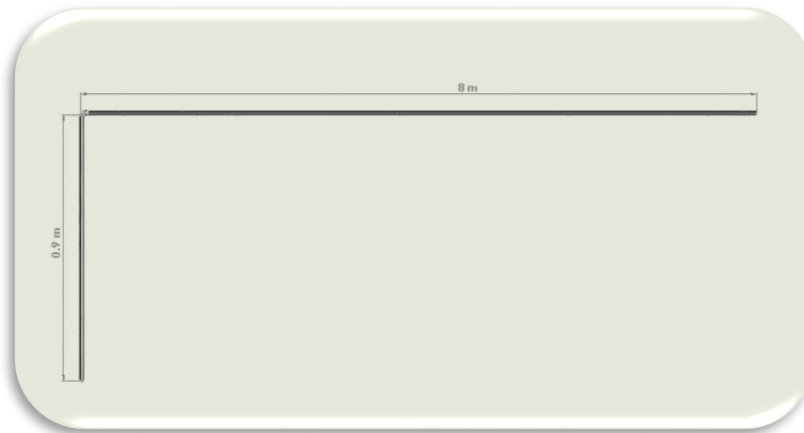
Figura 24 Tubería de aspersión.
