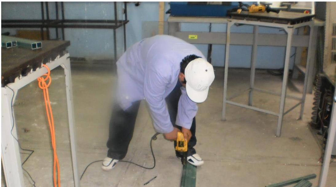
*Fig. 4.4.- Perforado de tubular, para sujeción con tornillos.*
