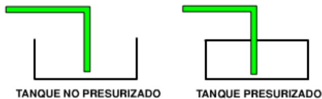
Figura 9. Simbología ISO para los tipos de tanques
