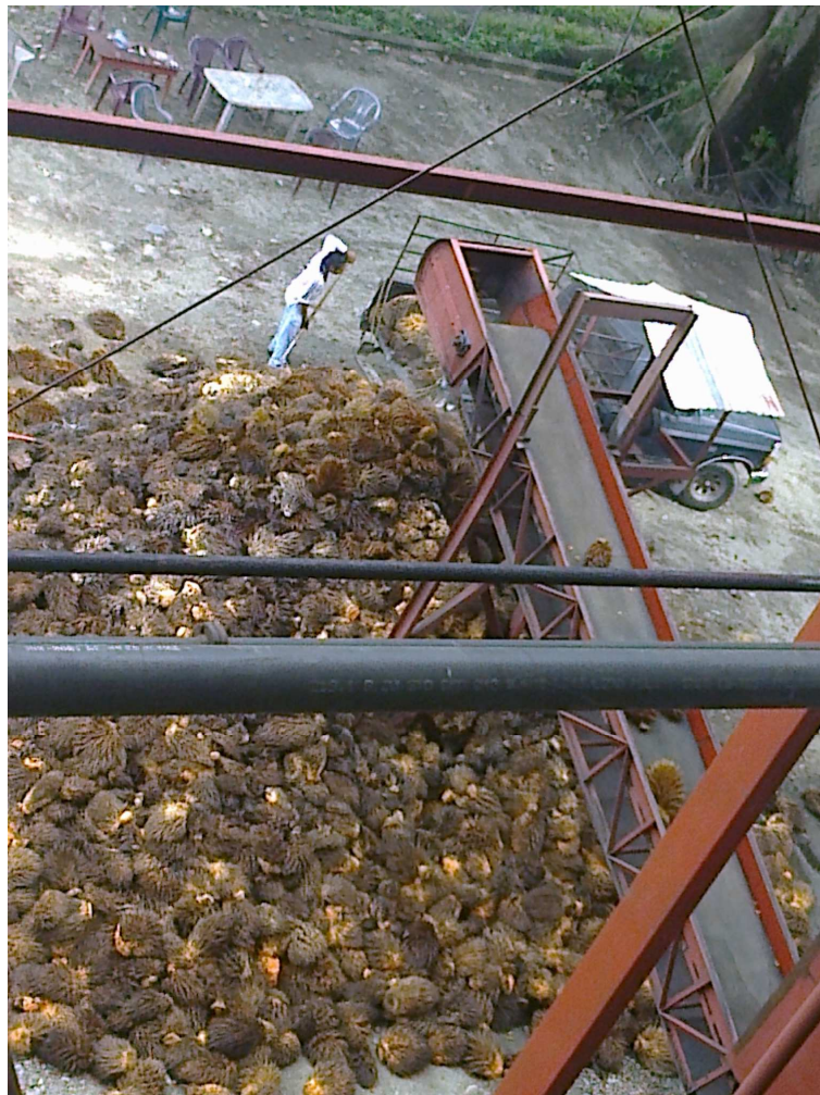
Figura 4. Apilamiento de raquis desperdiciado
