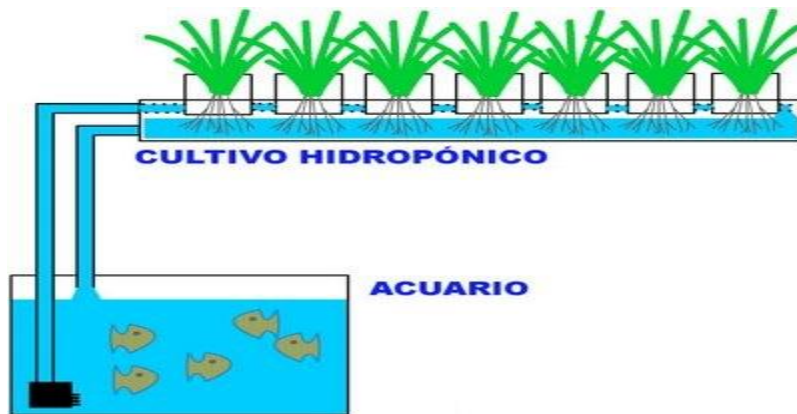
FIG. 2. Cultivo acuapónico (acuario abajo y cultivo hidropónico arriba)
