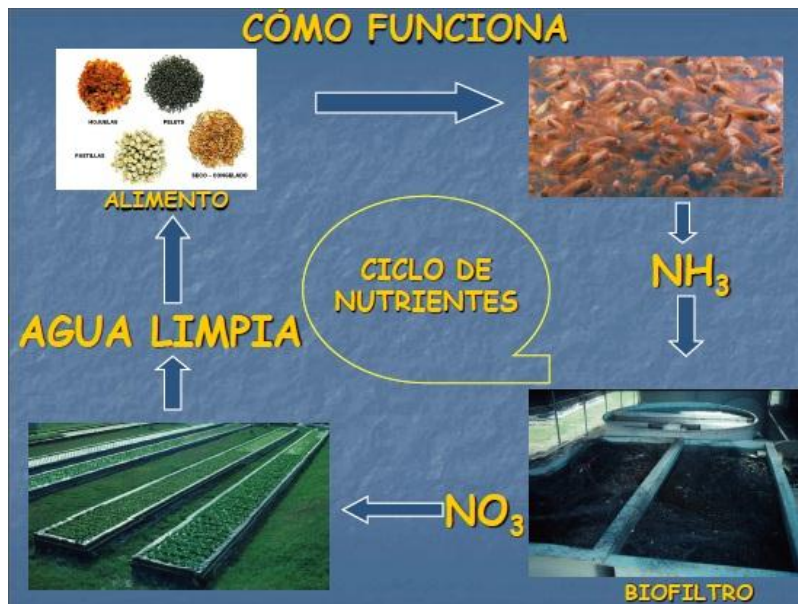
FIG. 3. Funcionamiento de un sistema acuapónico (ciclo del nitrógeno)
