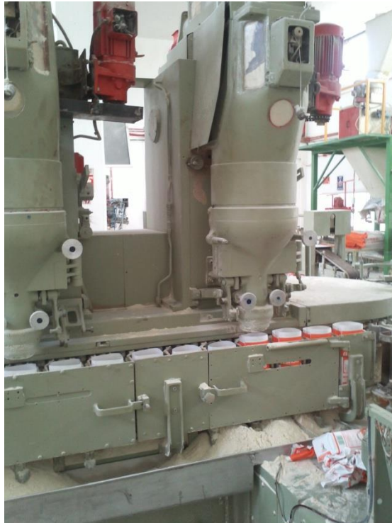
Figura A-1.3 Dosificador 1 con desperdicio de harina.
