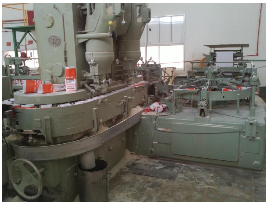
Figura A-1.2 Primera y segunda etapa de la máquina SIG.
