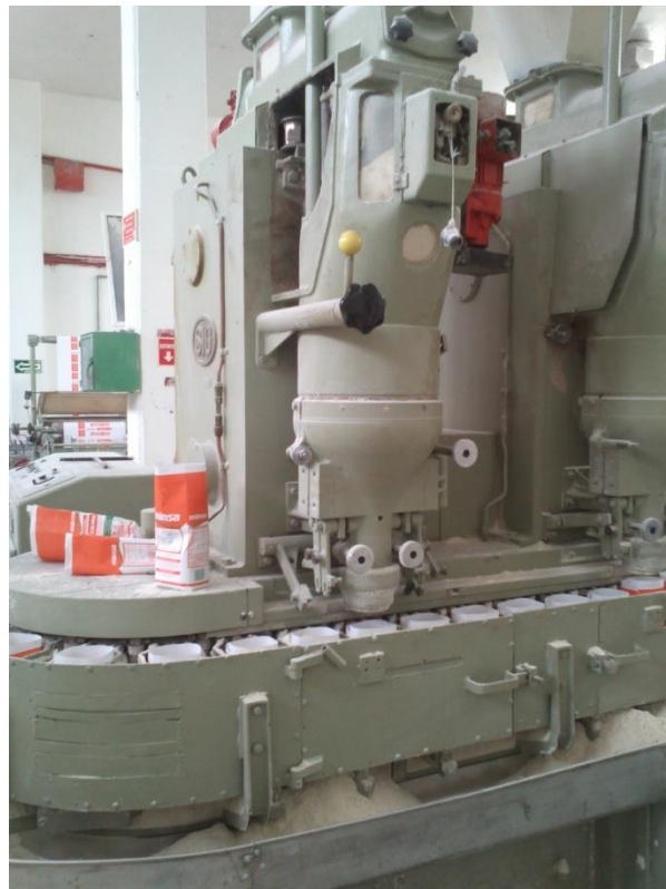
Figura A-1.4 Dosificador 2 con desperdicio de harina.
