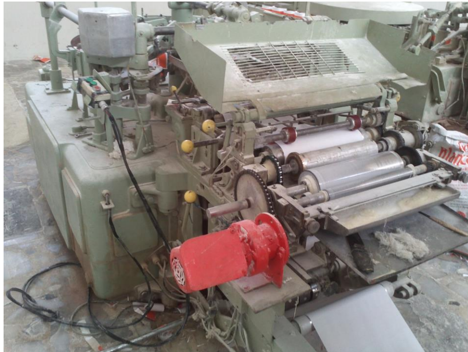
Figura 3.2 Rodillos de pegamento y motor impulsor.
