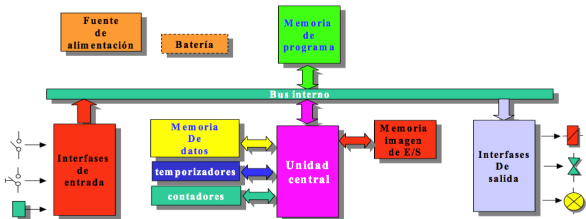
Figura 2.10 Diagrama de bloques de la arquitectura de un PLC.
