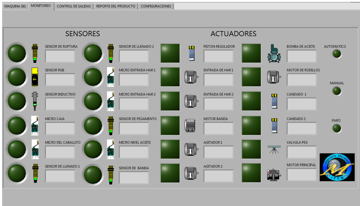
Figura 4.4 Panel de monitoreo de la máquina SIG en Labview.
