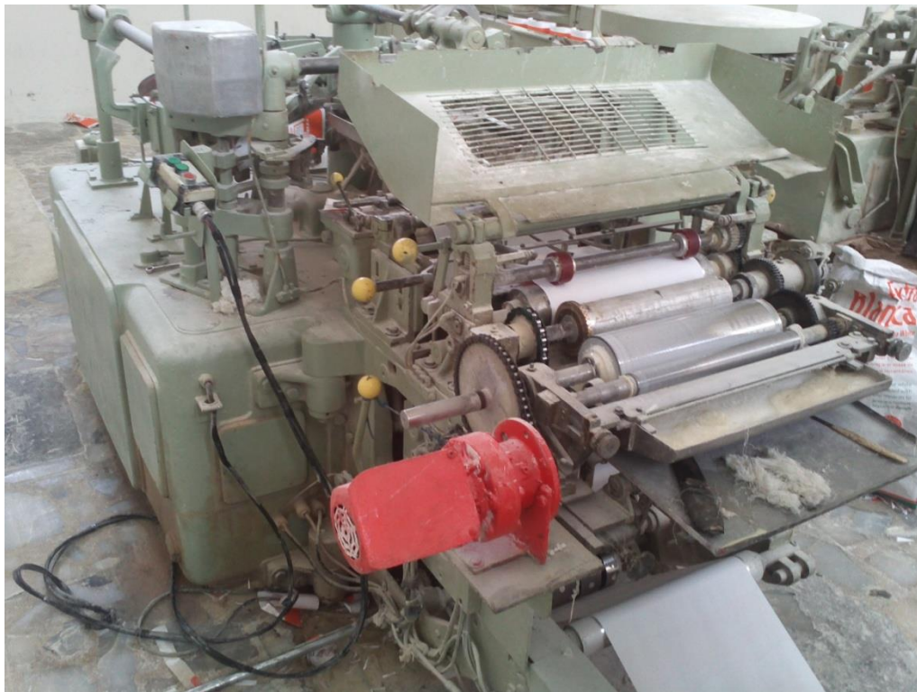
Figura A-1.6 Rodillos de pegamento etapa 1.
