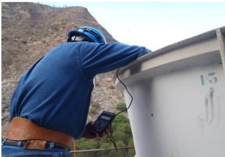
Fig.5.5 Velocidad del ventilador obtenida con anemómetro digital
