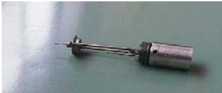
Figura 22 Sensores primarios de presión y temperatura y soporte de tarjetas electrónicas
