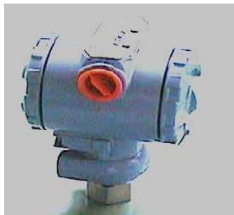
Figura 21 sensor de presión absoluta utilizado en el sistema
