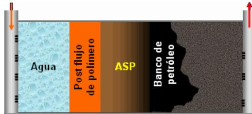
Figura 3 Esquema de la Inyección ASP.
