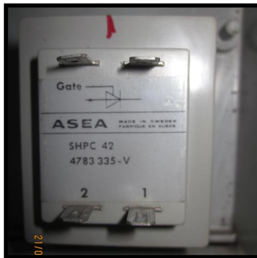
Fig. 3.11 Terminales de conexión del Thyristor.
