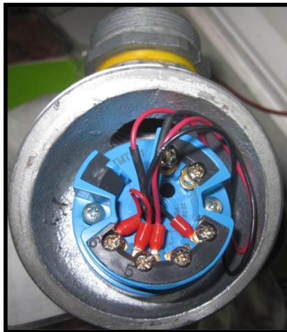
Fig. 3.32. Transmisor TMT181 para RTD; 3 a 4 hilos.
