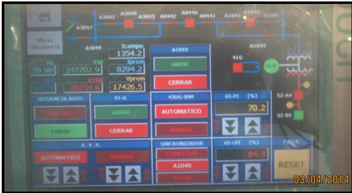
Fig. 3.12. Excitación y sincronización; HMI.
