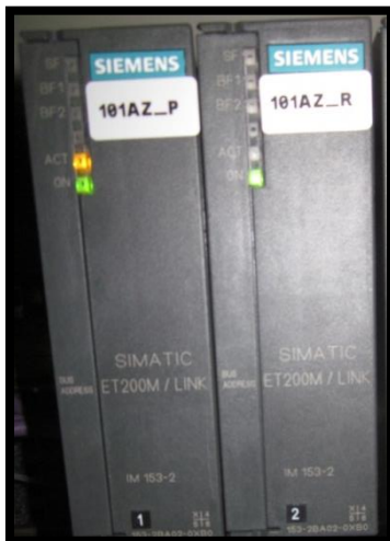
Fig. 3.35. Tarjeta Simatic ET-200M/Link; Módulo de Adquisición Remota.
