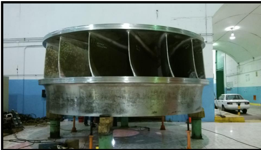
Fig. 3.7. Turbina Francis de eje vertical; Cortesía CFE.
