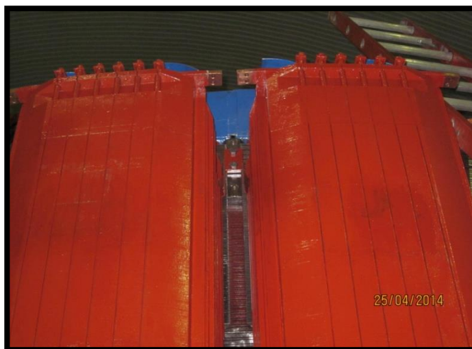
Fig. 3.6. Devanados de amortiguamiento; En la cara del polo.
