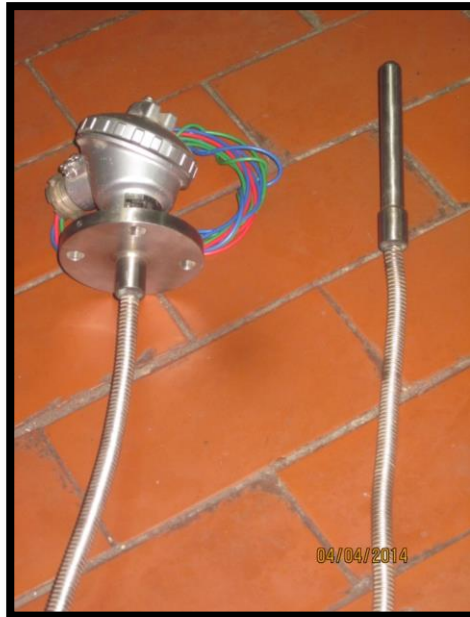
Fig. 3.31. Armado completo de sensor de temperatura; RTD, Termopozo, Cabezal, Capilar.
