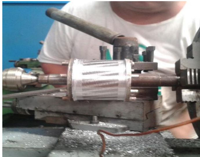
Fig. 3.19.6 Desgaste del rotor en el torno
