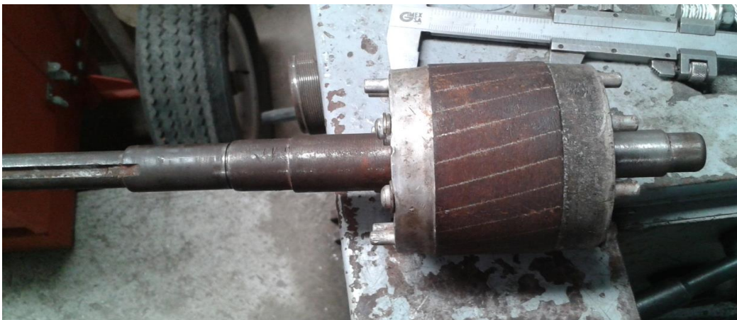
Fig. 3.19.3: rotor con las mismas características al original
