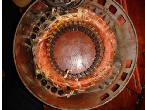
Fig. 3.19.9 Estator con las bobinas originales
