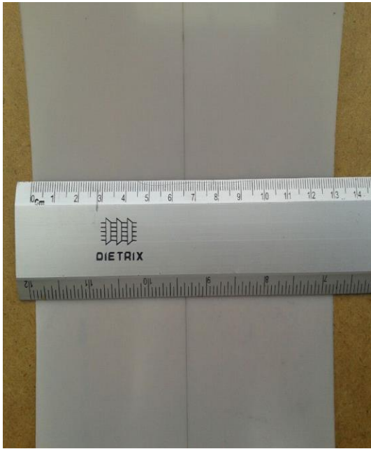
Fig. 3.19.11 Preparado del aislante mailar, para cada ranura
