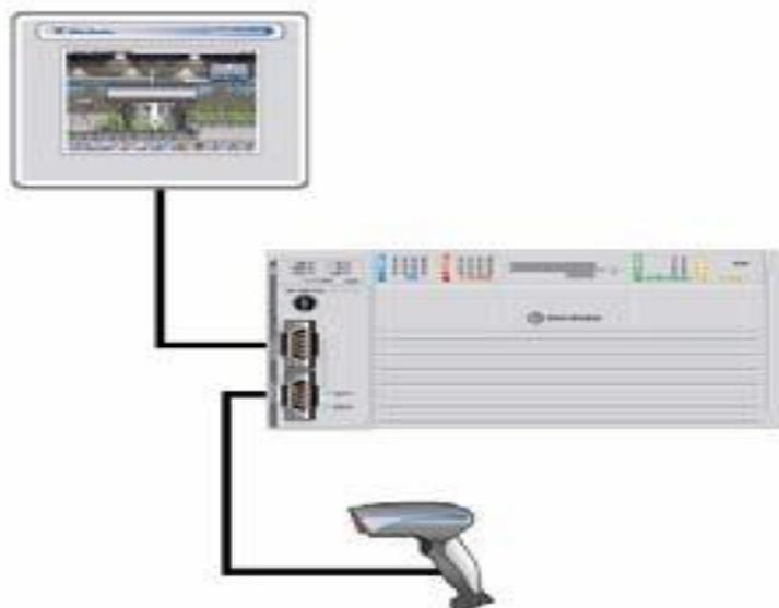
*Figura 44.- Configuración de Panel View con un controlador Logix usando conectividad en serie*
