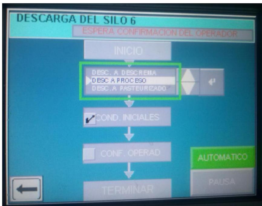
Figura 114.- Operación de descarga de silo 6 a placa de procesos en el Panel View Plus 600
