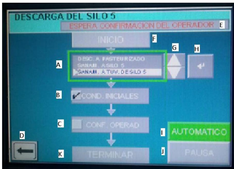
Figura 101.- Pantalla de panel View de descarga de silo 5 a procesos
