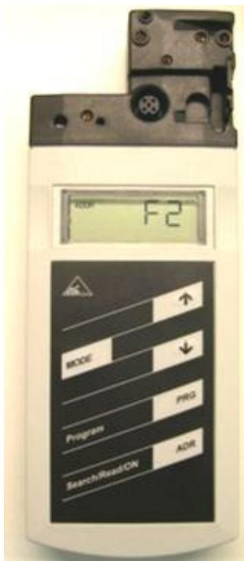
*Figura 43.- Dispositivo Direccional de esclavos en red As-i Bus*
