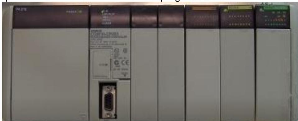
Figura 41.- Módulo maestro controlador de red As-i Bus
