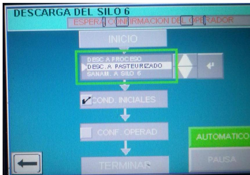
Figura 116.- Descarga de silo 6 a proceso de pasteurizado por Panel View Plus 600.
