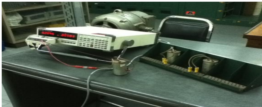
c) Medición de las capacitancias de los elementos en derivación
