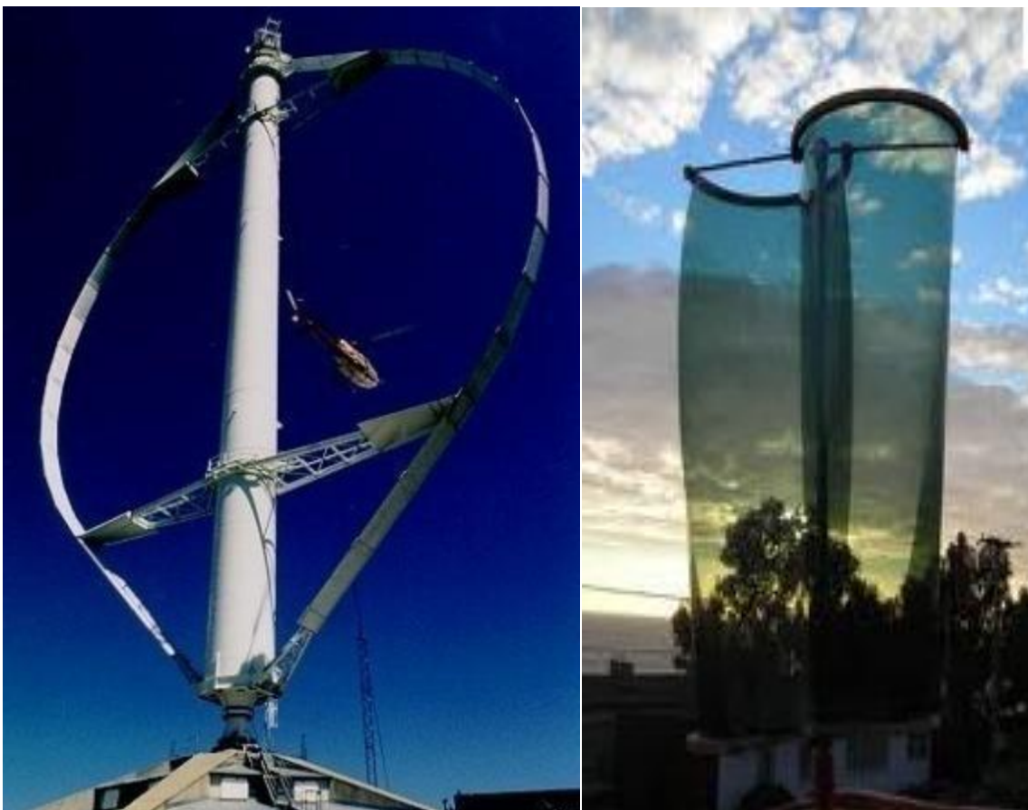
Fig.2.7.6 diseños básicos: Savonius y Darrieus.
