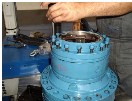
Fig. 3.57 Desmontaje de la 2ª etapa.
