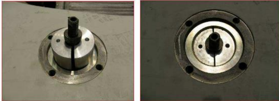
Fig. 3.65 Extracción de las pastillas del YAW.
