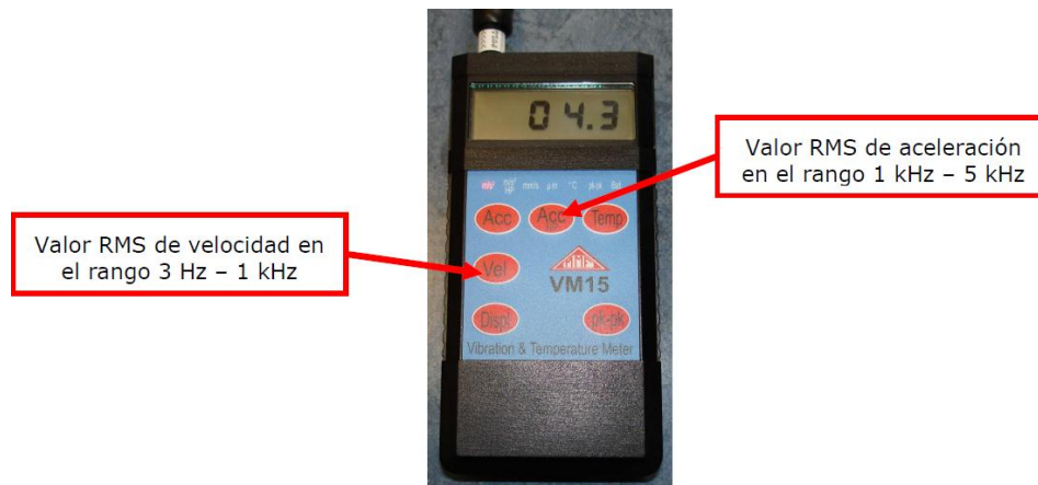
Fig. 3.37 Rangos del detector de vibraciones.
