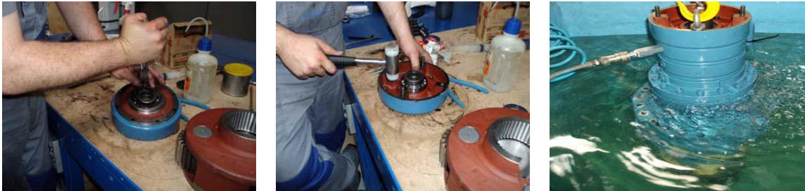
Fig. 3.61 Introducción del rodamiento al eje.
