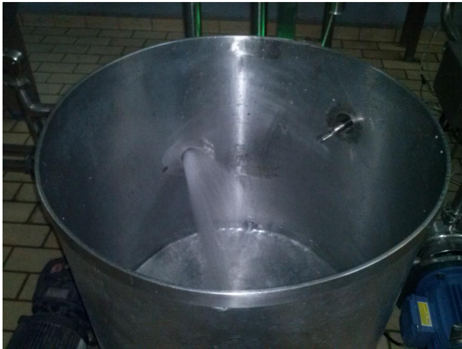
Fig.3.138.- Prueba de secuencia de silos a descremadora
