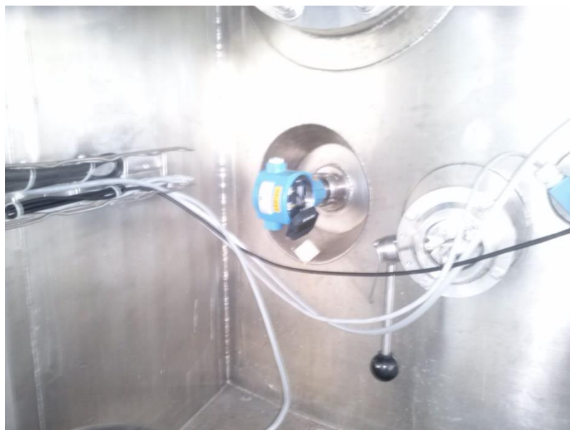
Fig.3.109.- Conexión del sensor de nivel FL.01.05
