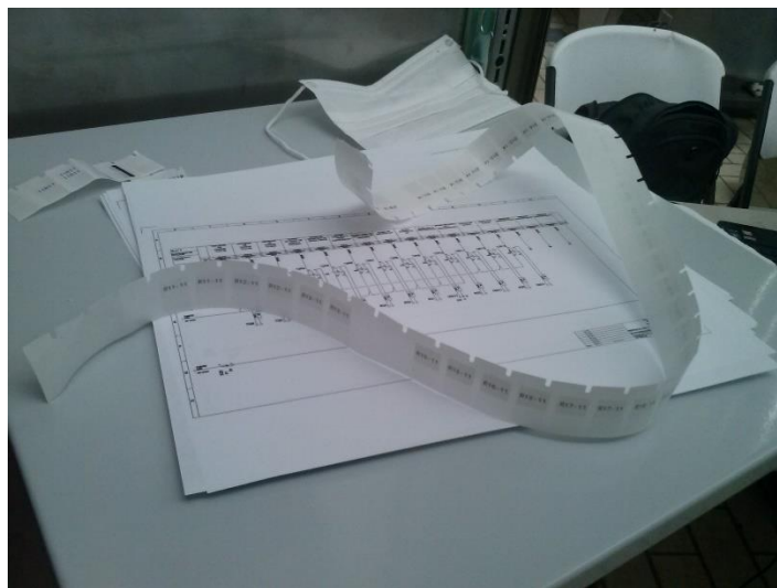
Fig.3.66.- Etiquetas para identificar el cableado
