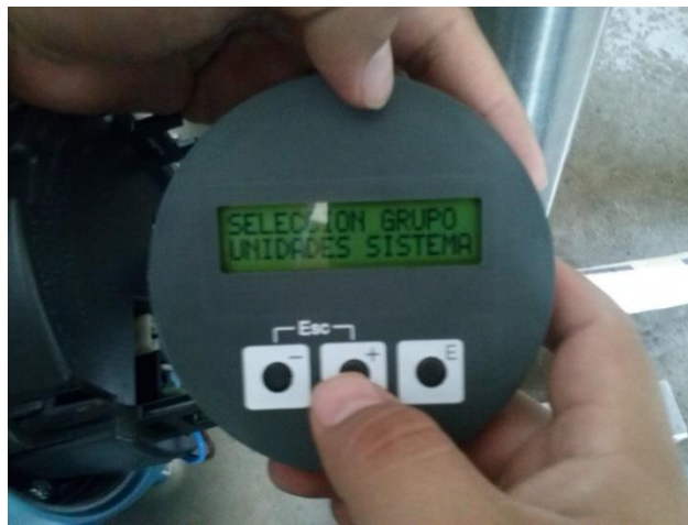
Fig.3.119.- Configuración del medidor de flujo electromagnético
