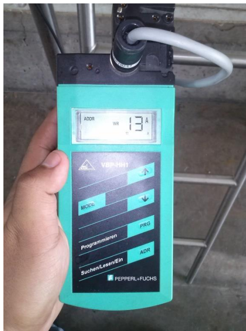
Fig.3.125.- Direccionamiento de válvulas
