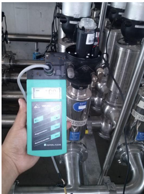
Fig.3.126.- Direccionamiento de válvulas
