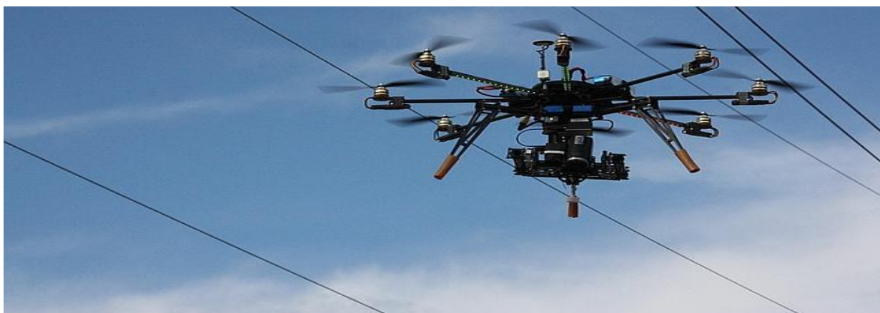
Fig. 3.10 dron propuesto a la empresa de la CFE para inspección aérea de líneas.
