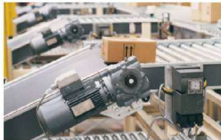
Fig. 3.11. El arranador de motor dentro la red AS-Interface.
