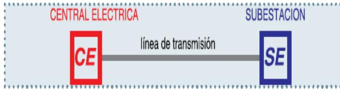
En la figura 1 vemos el croquis de una central eléctrica (CE) de la que parte una línea de transmisión que alimenta una subestación (SE), desde la cual parten las redes de distribución que conectan con las cargas. La subestación se procura colocarla en el “centro de gravedad” o “zona de influencia de los consumos”. Este es un caso de “alimentación directa”, mientras que el de la figura 2, es una alimentación radial” desde la subestación principal (SEP).
