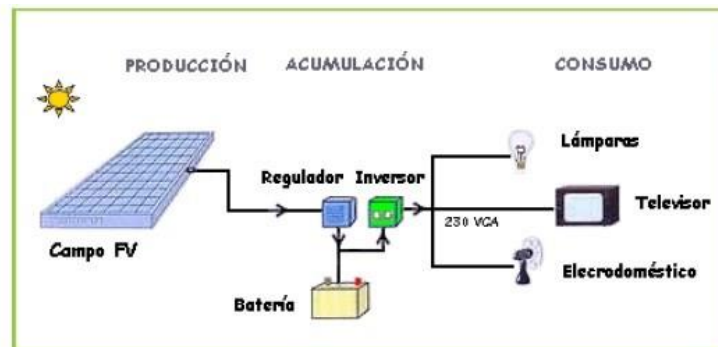
Figura 8. Esquema de un sistema fotovoltaico autónomo.
