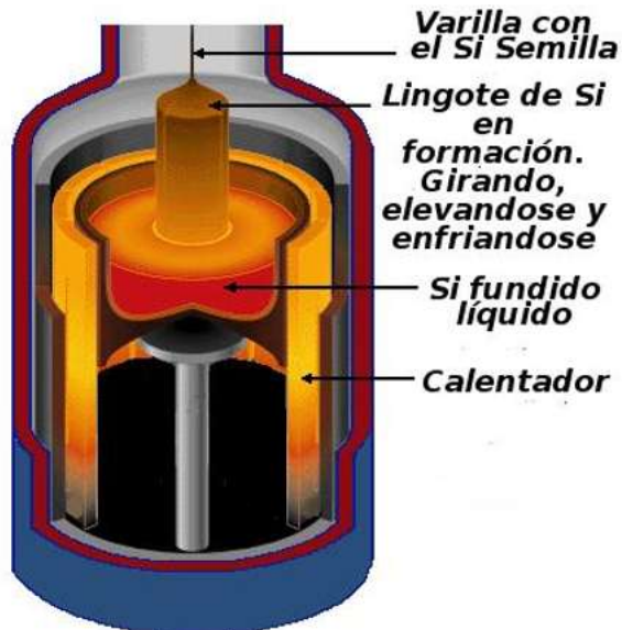
Fig. Anexo. A7 Método de obtención Czochralski.
