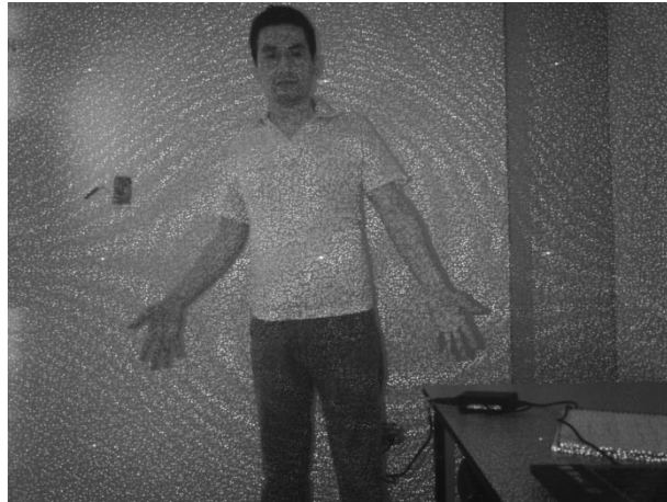
Figura 4.3: Fotografía de la proyección del patrón de puntos infrarrojos.
