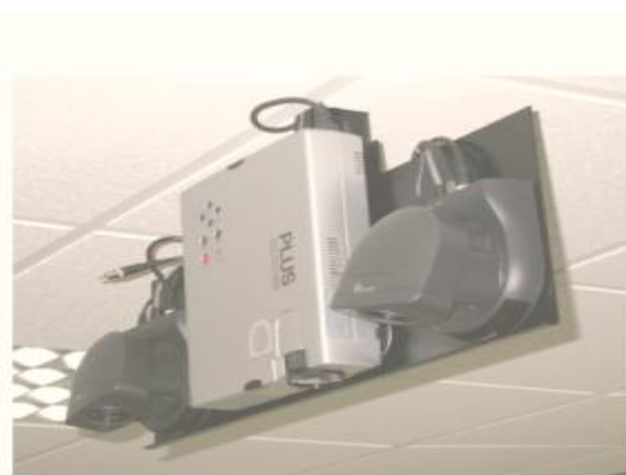
Figura 3.2: Posición de las cámaras y el proyector para la utilización horizontal.
