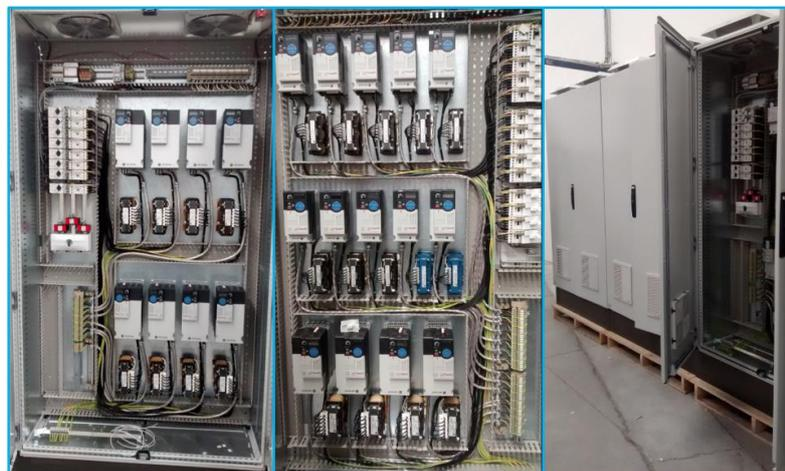
**Fig. 3.11** Tableros CCM's en proceso de terminación.
