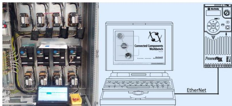
**Fig. 3.17** Comunicación PC-PowerFlex 525.
