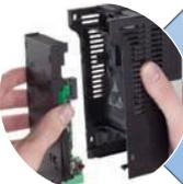
**Versátil.-** Los variadores CA de PowerFlex 523 aceptan una tarjeta de comunicación accesoria manteniendo a la vez sus dimensiones compactas. Los variadores CA de PowerFlex 525 pueden contener un módulo de comunicación y una tarjeta de encoder simultáneamente.
