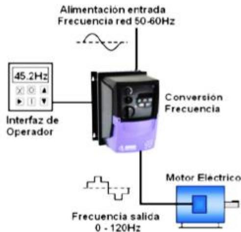
**Fig. 2.20** Control de velocidad de un motor por medio de un convertor de frecuencia.
