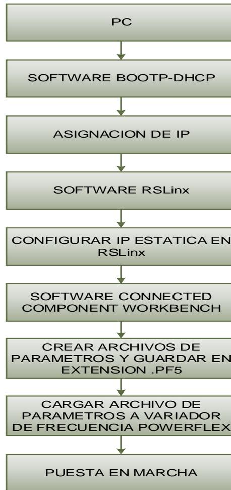
**Fig. 3.16** Diagrama a bloques del protocolo para configuración de los variadores de frecuencia.
