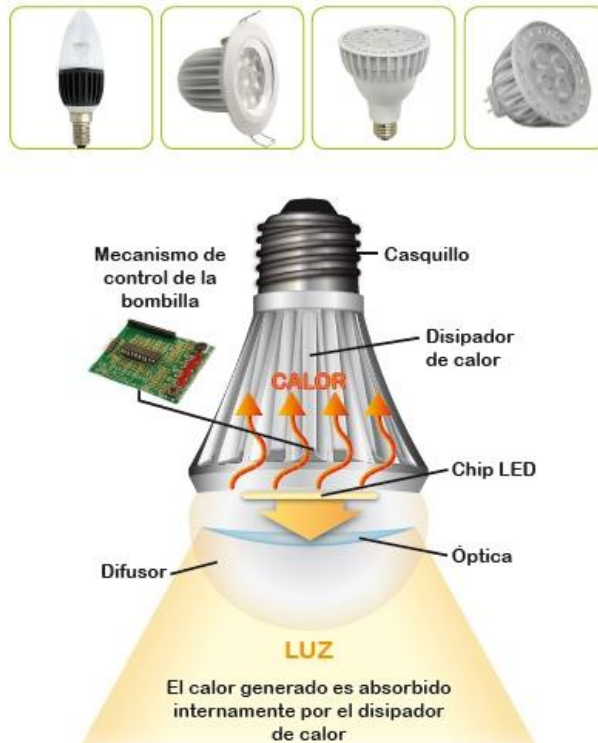
Fig. 0.16 Partes de una lámpara LED, (energible, 2014)
