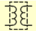
Transformador apantallado o blindado
