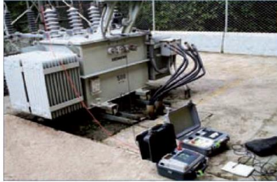
Fig. 3.4 Conexión del T.T.R. a un transformador.
