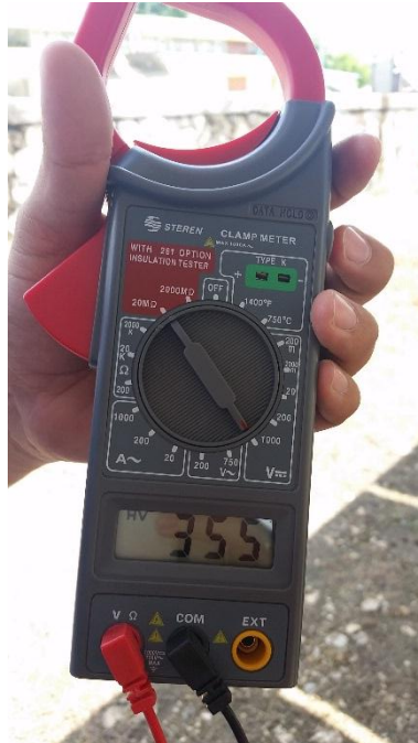
Figura 4.2 Voltaje de once módulos conectados en serie
