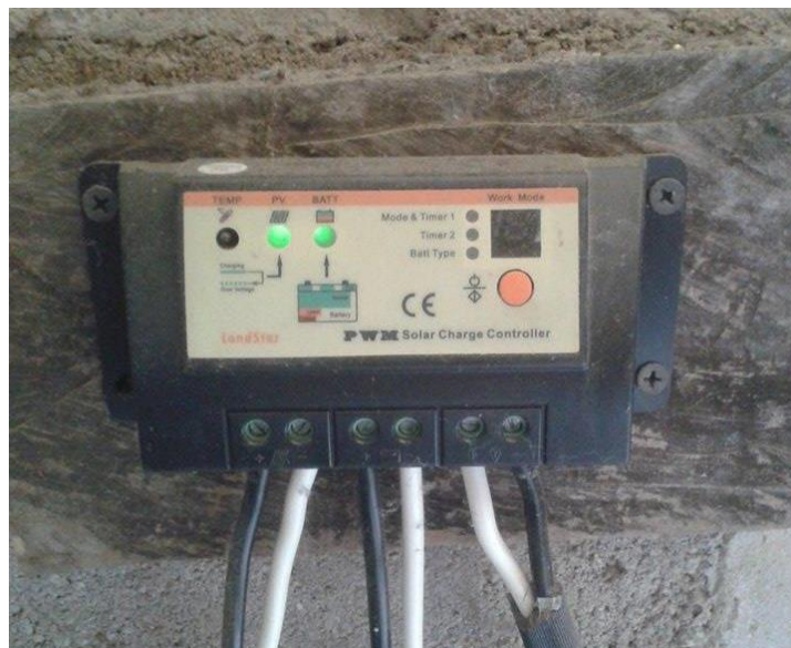
Fig. 4.6 Características del regulador de carga LS1024R.
