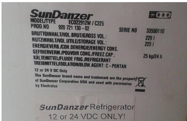
Fig.4.4 y 4.5 Características del Refrigerador solar comunitario.
