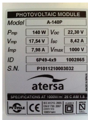
Fig. 3.6 Placa de Especificaciones Eléctricas de un Módulo Fotovoltaico.
