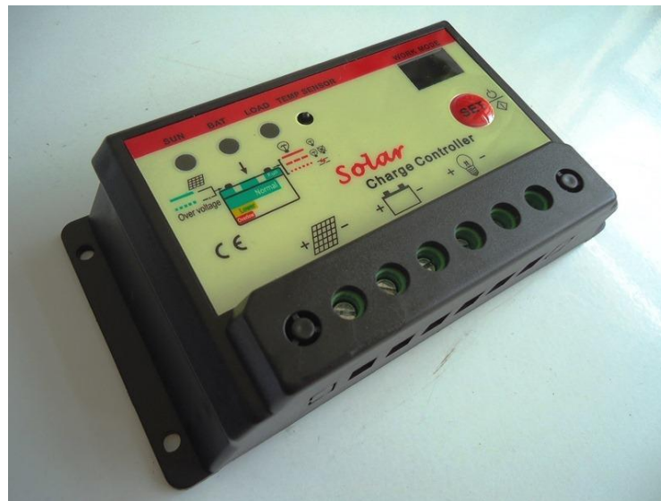
Fig.3.9 Regulador o Controlador de carga para sistemas fotovoltaicos.
