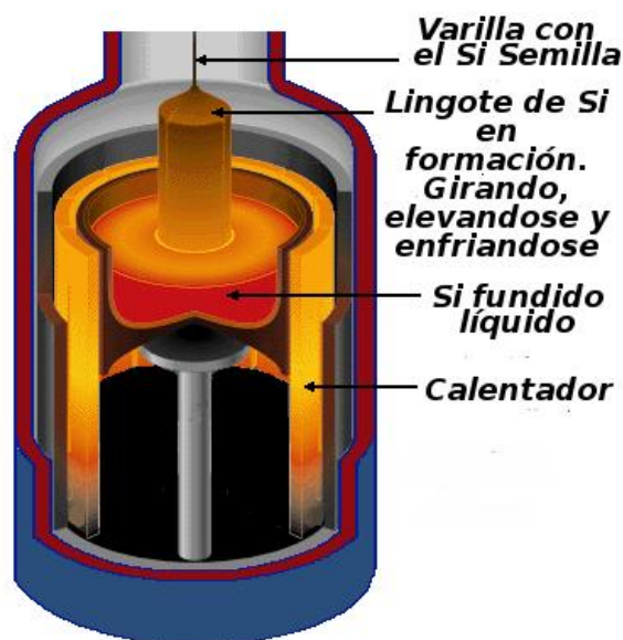
Fig. Anexo. A7 Método de obtención Czochralski.
