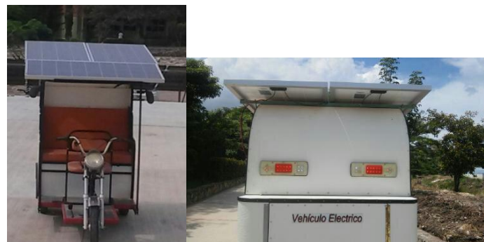
Fig. 4.2 Vehículo con Módulos Fotovoltaicos instalados.
