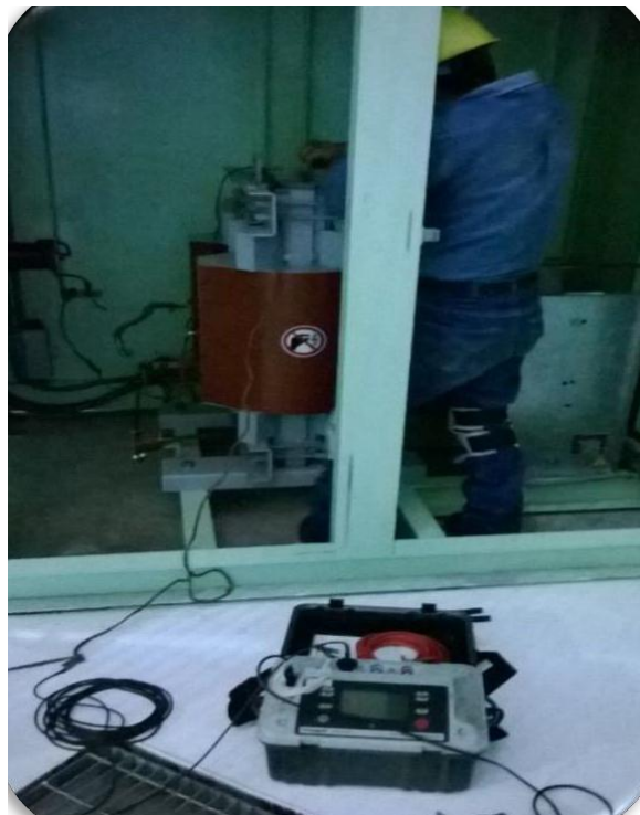
Fig.3.4 Prueba de conjunto desde el neutro
