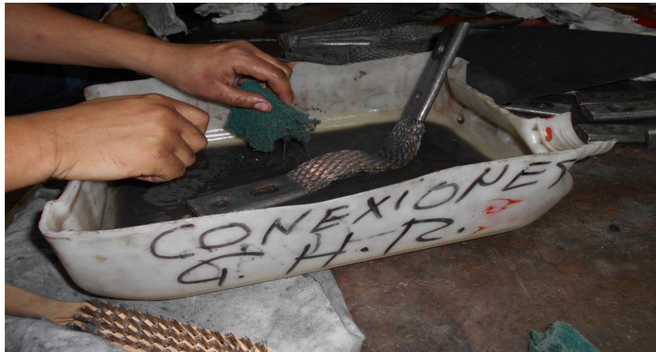
Fig. 3.46 limpieza de trenzas
