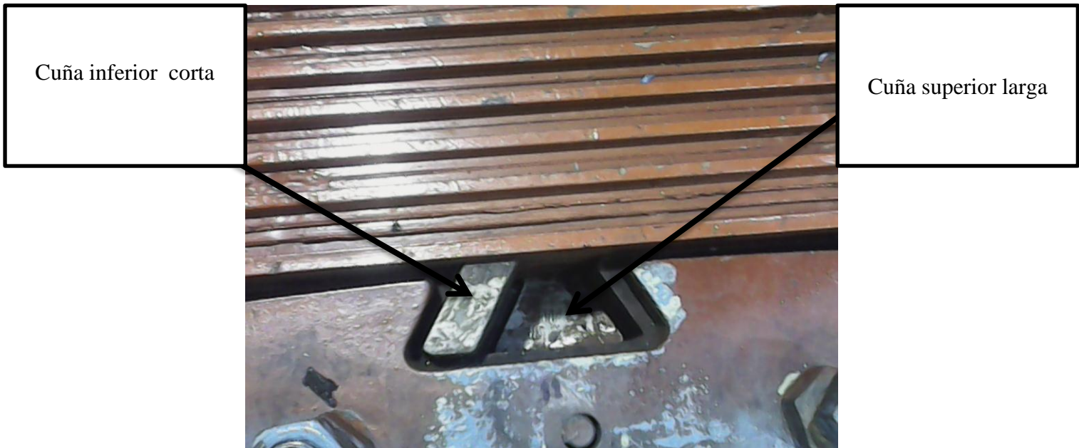
Fig. 3.17 cuñas del polo superior e inferior
