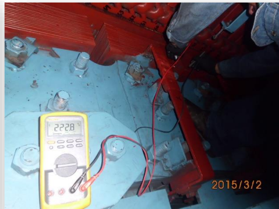
Fig. 3.42 caída de tensión a los polos.
