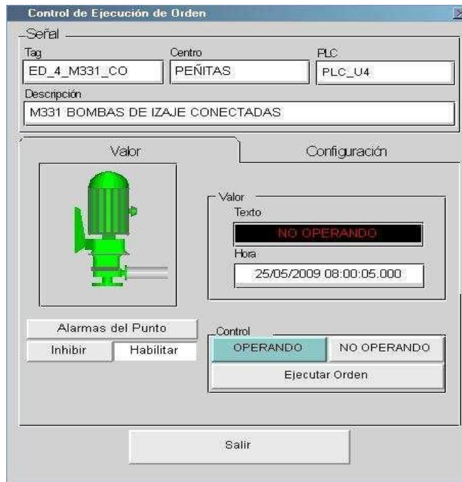
Fig. A2.15 Arranque y paro de la bomba.
