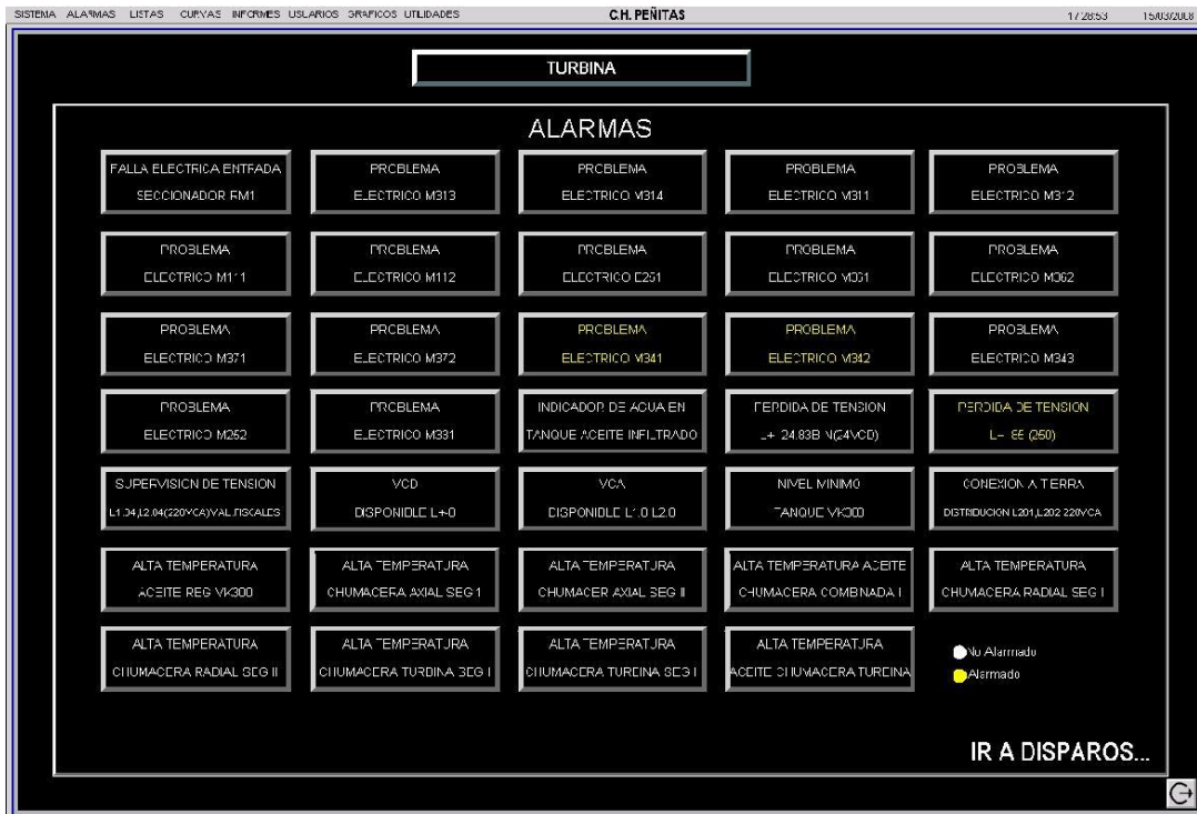
Fig. A8.2 Pantalla de alarma de Piso de turbinas.
