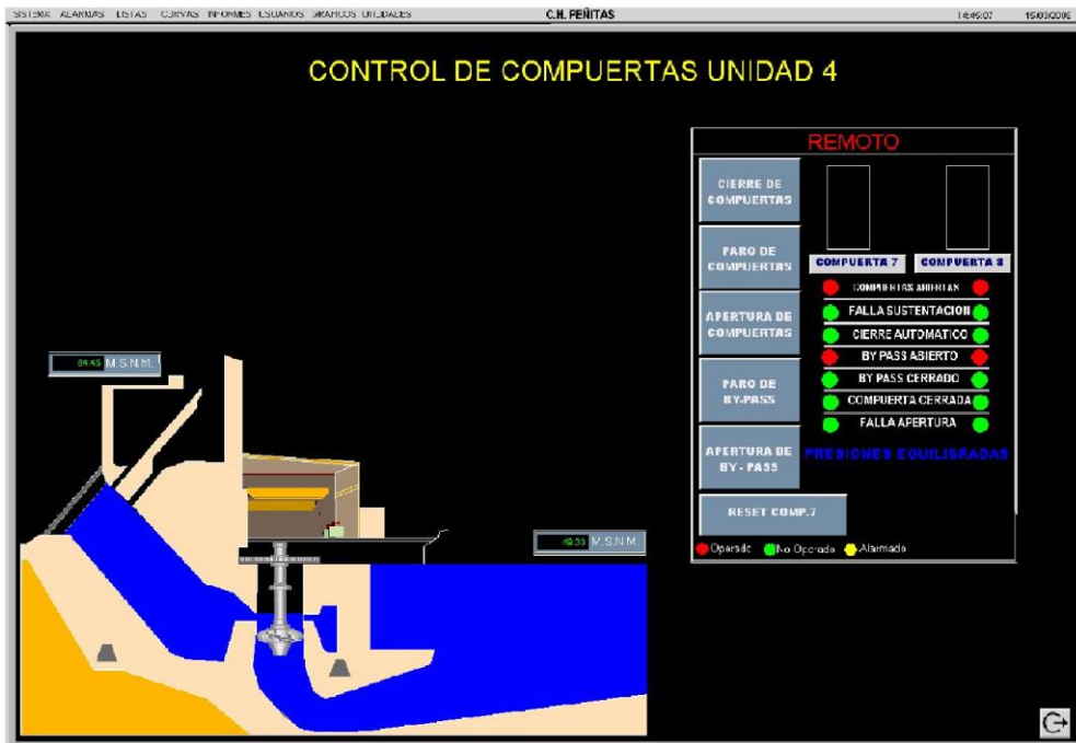
Fig. A2.25 Pantalla de obra de toma.
