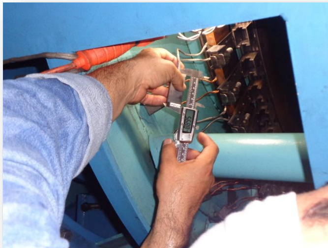
Fig. 3.47 Medición de carbones.
