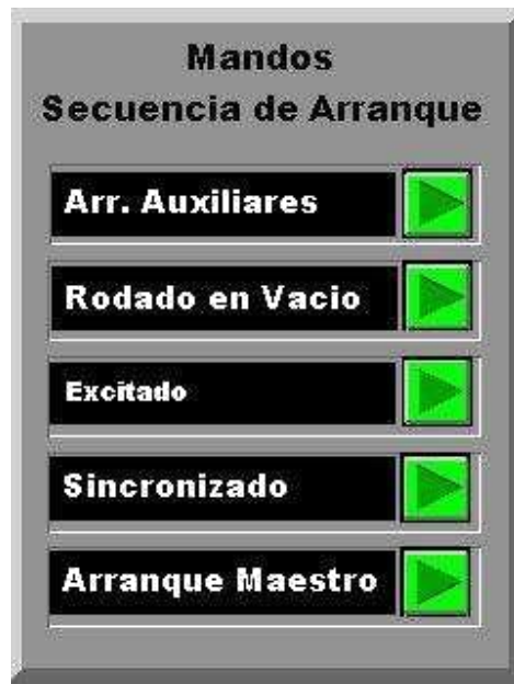
Fig. A3.1 Mandos de secuencia de arranque.
