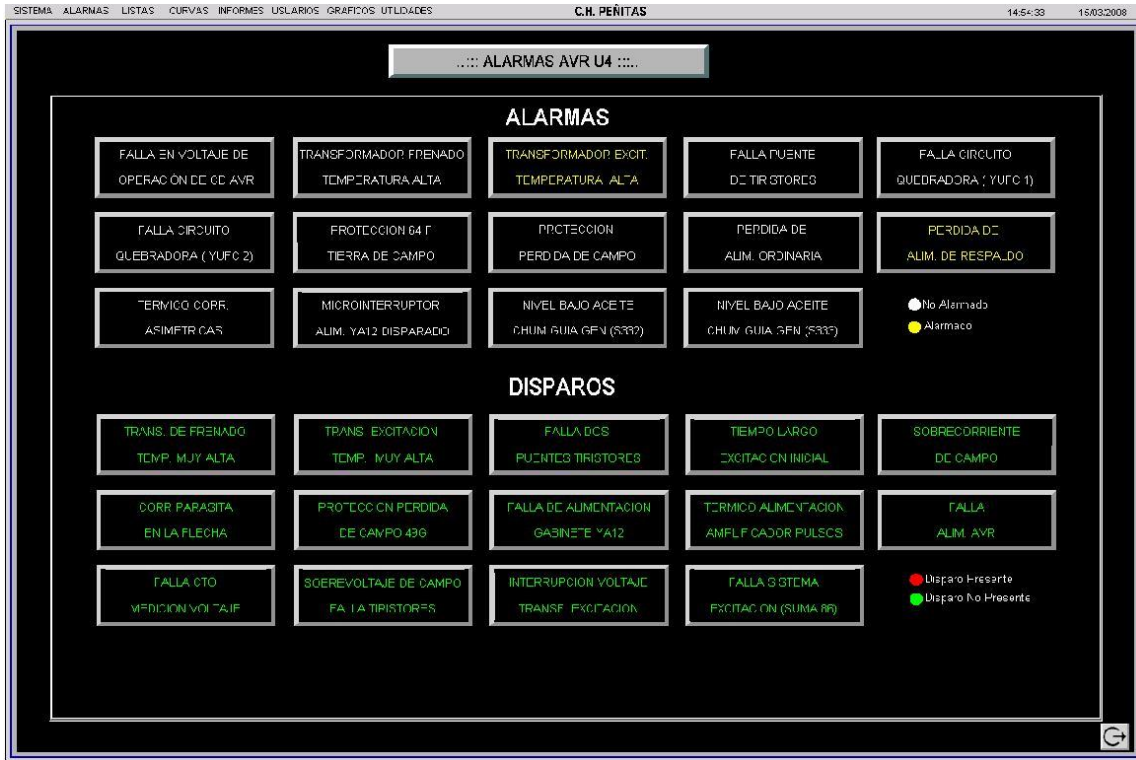
Fig. A8.2 Pantalla de alarma del AVR.
