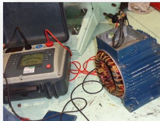
Fig. 3.50 Limpieza y prueba de R.A a los motores de Servicios Propios.
