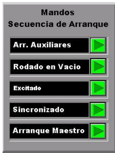
Fig. A2.10 Mandos de secuencia de arranque.
