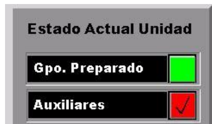
Fig. A3.6 Color rojo, auxiliares se encuentran operando.
