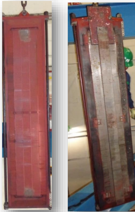
Fig. 3.7 Muestra de un polo del rotor.
