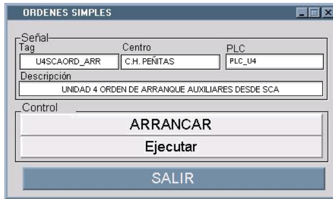
Fig. A2.11 Mandos de arranque y ejecutar.
