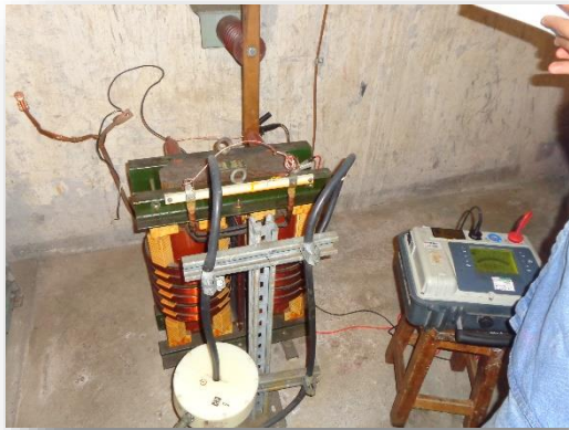
Fig. 3.48 Prueba de R.A al T. Neutro.
