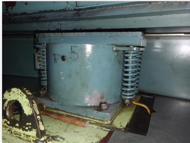
Fig. 3.5 Gato de frenado.
