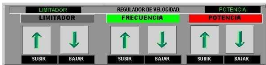
Fig. A2.22 Mandos de subir y bajar Frecuencia, Potencia y Limitador de Apertura del distribuidor.
