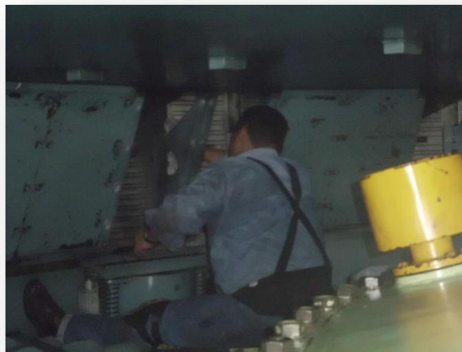
Fig. 3.51 Mantenimiento a los gatos de frenado.
