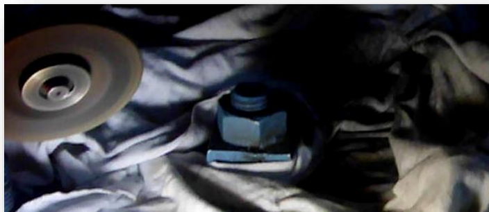
Fig. 3.43 Quitando la soldadura de la tuerca.
