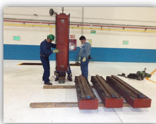
Fig. 3.44 Descanso de los polos en placas de apoyo.
