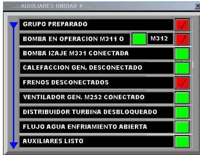
Fig. A3.5 Bomba de izaje se encuentra conectada y en operación.
