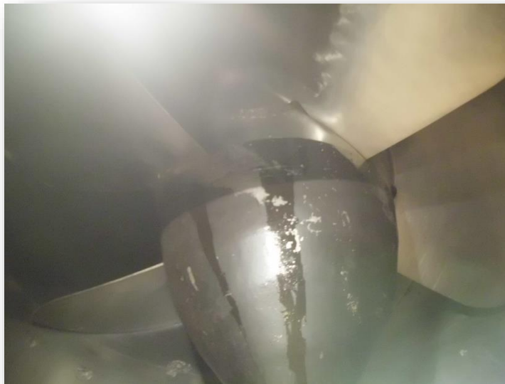
Fig. 2.24 Turbina Kaplan de la C.H. peñitas.
