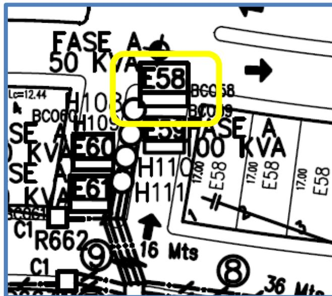
**Fig. 3.16** Ubicación del transformador 3.
