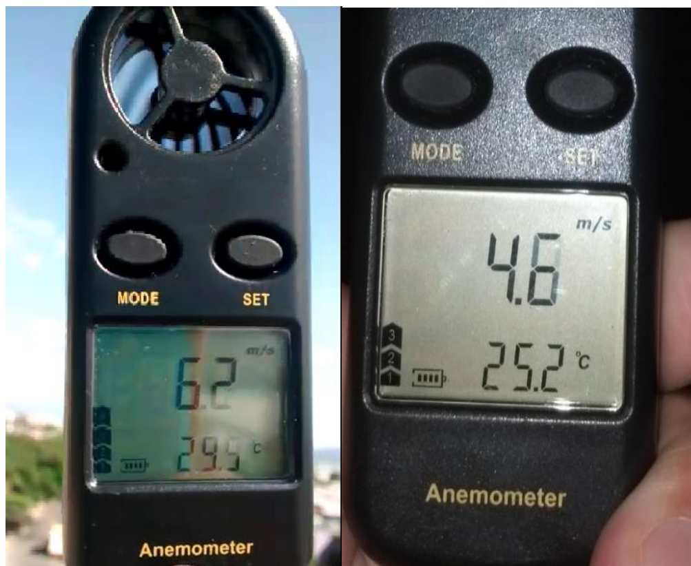
Figura 3.13 Medición del viento con anemómetro digital, en el CIME. a) Día, b) Noche.
