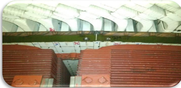
Fig.3.36 Conexión de amortiguadores
