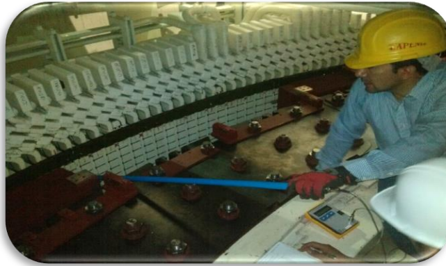
Fig.3. 34 Prueba de descargas a la ranura
