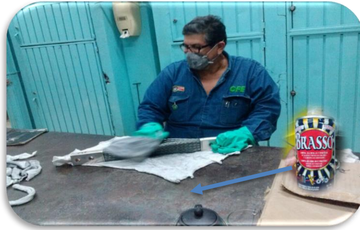
Fig.3.39 Limpieza de trenzas
