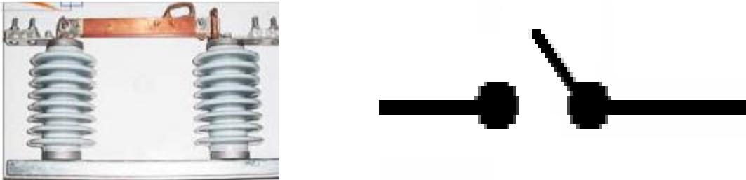
Fig.4 Desconectador y simbología eléctrica
