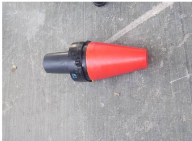
Fig.3.5 Inserto de 15 KV operación con carga de 200 A.
