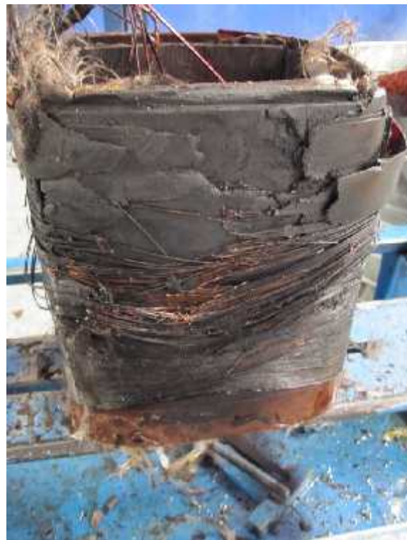
Figura 3.12. Daños por sobrecarga en devanados:
