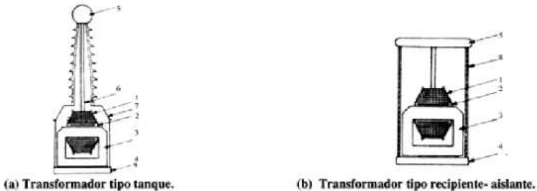
Figura 2.4.7.3. Corte transversal de dos tipos de transformadores de prueba aislados con aceite: 1) Devanado A.T., 2) Devanado B.T., 3) Núcleo magnético, 4) Base, 5) Terminal A.T., 6) Boquilla, /9 Tanque metálico y 8) Recipiente aislado.
