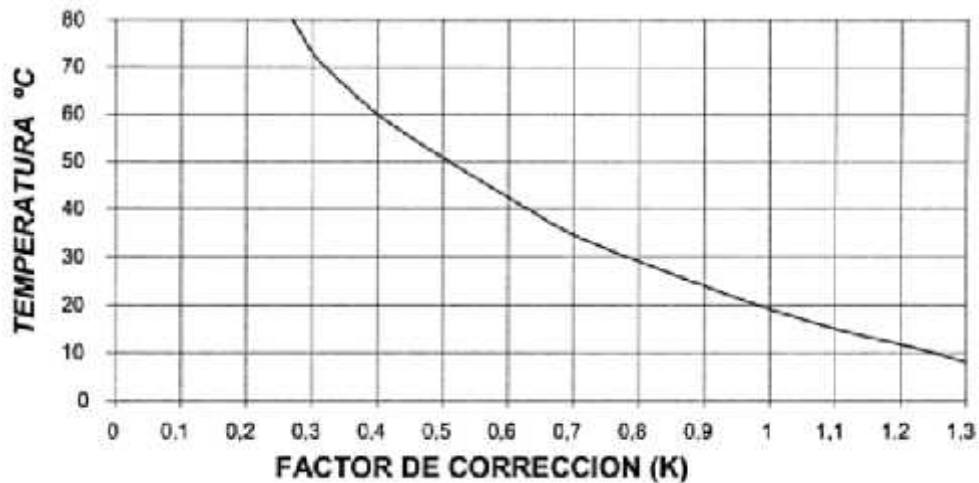
Figura 2.4.2.3. Diagrama donde podemos obtener en forma gráfica los factores de corrección para la prueba de factor de disipación.
