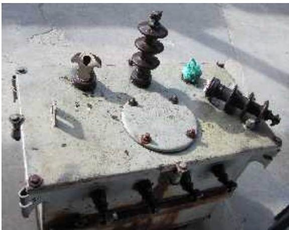
Figura 3.3. Daños causados por falla de impulso por rayo en boquillas:
