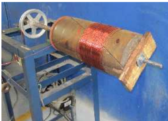
Figura 3.1.8. Proceso de extracción del cobre (bobinas).
