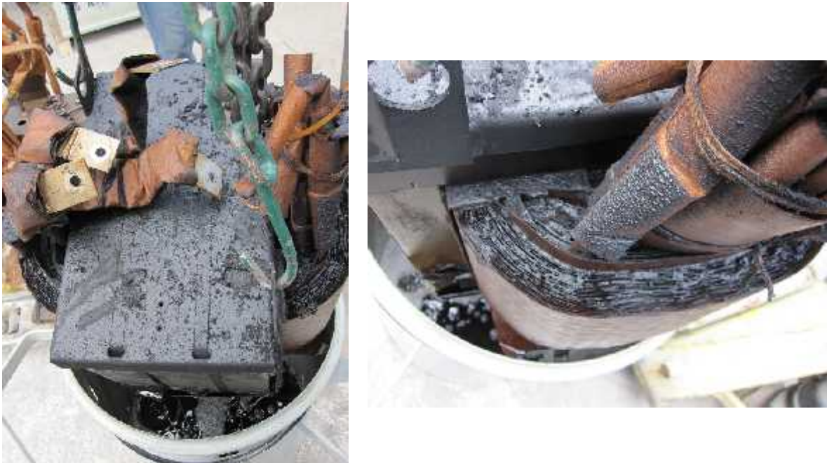
Figura 3.6. Considerable presencia de carbón en herraje.
