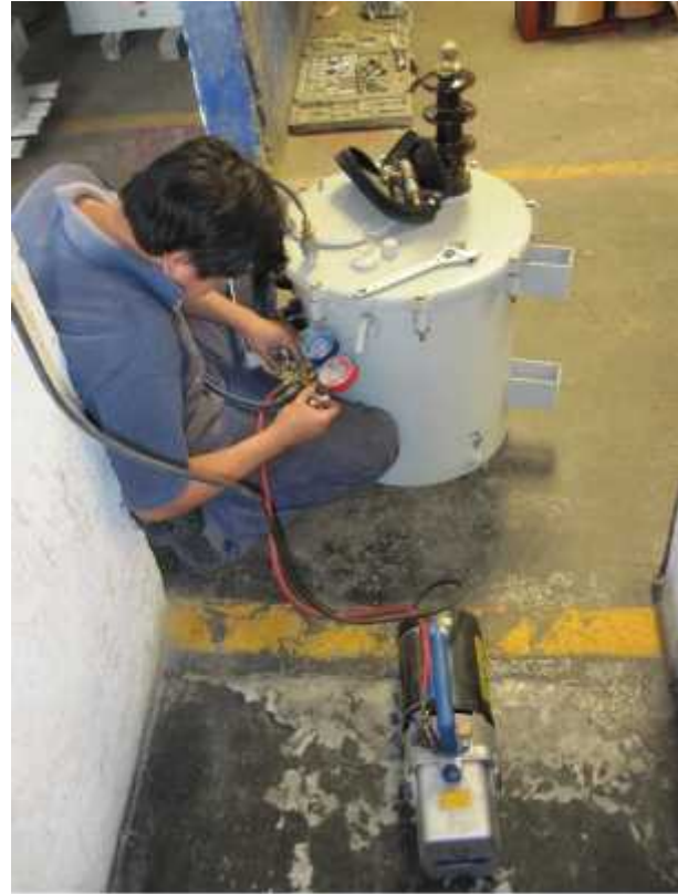
Figura 3.1.14. Proceso de llenado del tanque con aceite dieléctrico nuevo:
