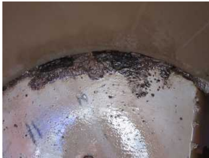
Figuras 3.4. Daños causados por falla de impulso por rayo en aceite:
