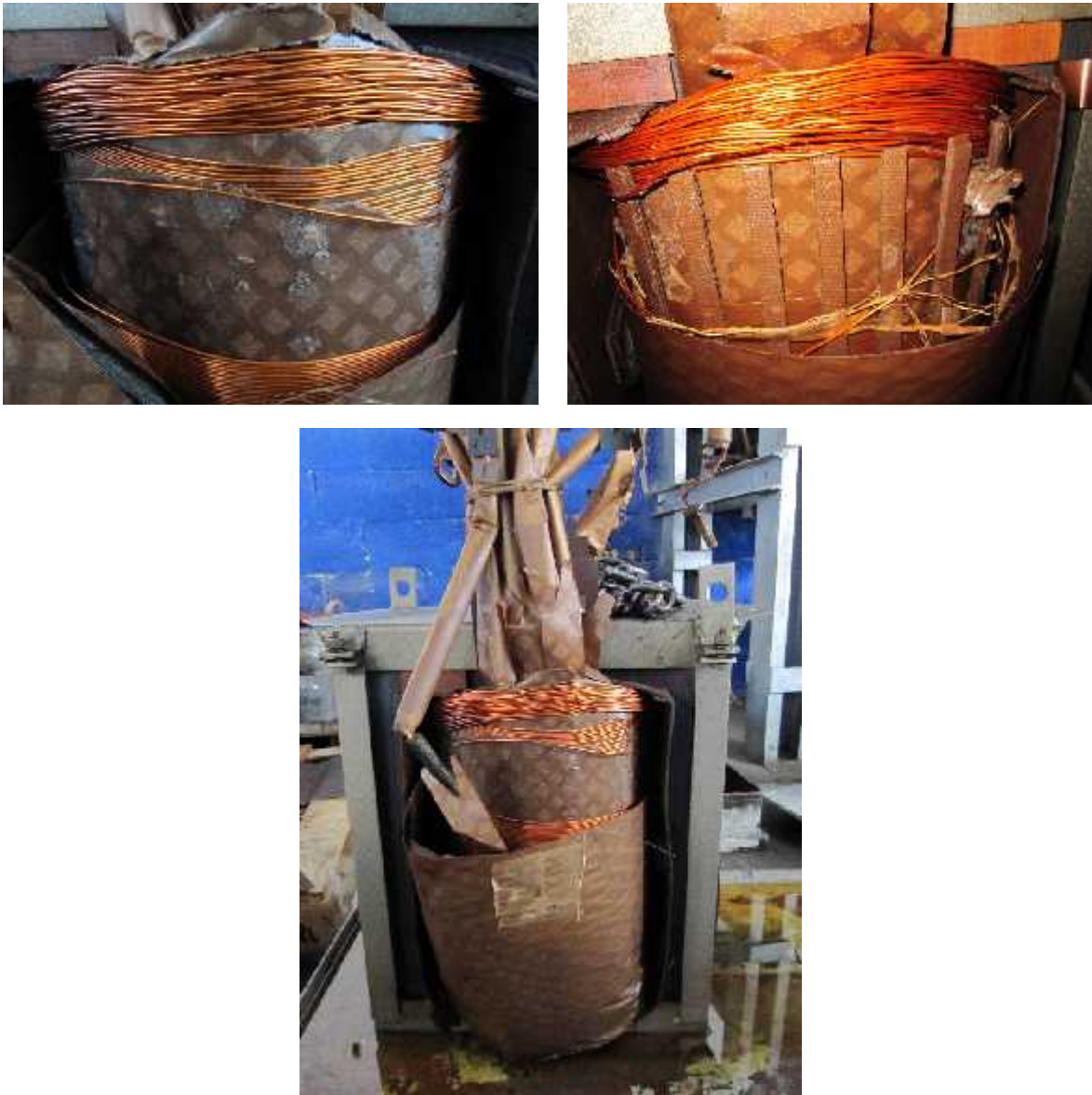
Figura 3.7. Daños causados a bobinas por falla de impulso por rayo o maniobras:
