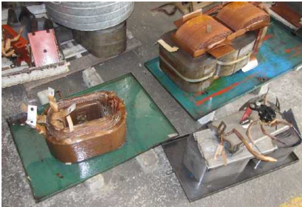
Figura 3.1.7. Proceso de retiro de herraje y extracción del núcleo (laminas).
