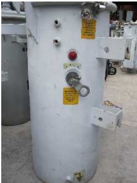
Figura 3.10. Muestra del interruptor e indicador de sobretensión:
