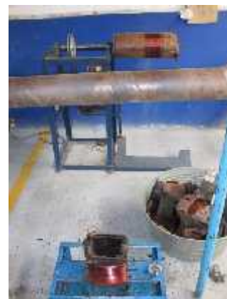
Figura 3.1.8. Proceso de extracción del cobre (bobinas).
