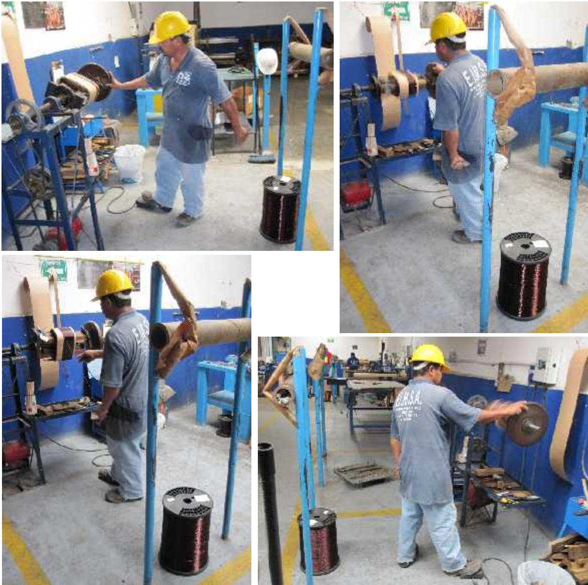
Figura 3.1.9. Realización del proceso de bobinado por personal de la empresa E.I.M.S.A.
