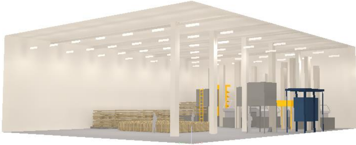
Fig. 4.61 Vista frontal en 3D del lado derecho hacia el fondo de la nave, 7 filas x 7 luminarias, 49 luminarias en total.
