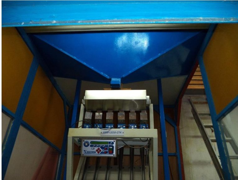
Fig. 3.33 Clasificadora electrónica de grano por color, línea 1.
