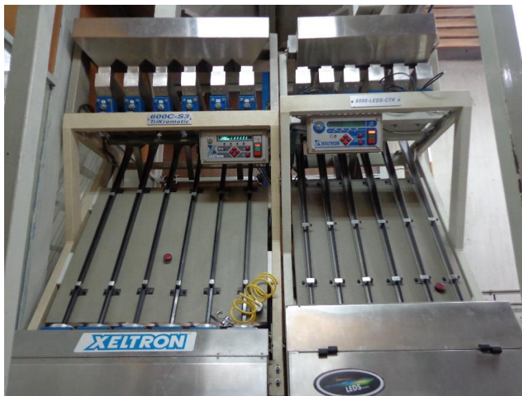
Fig. 4.40 Equipos Xeltron para selección de granos de café por color mediante “electrónicas”
