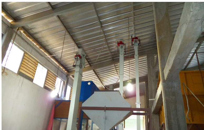
Fig. 3.28 Elevadores para el desarrollo del proceso de café de calidad oro.
