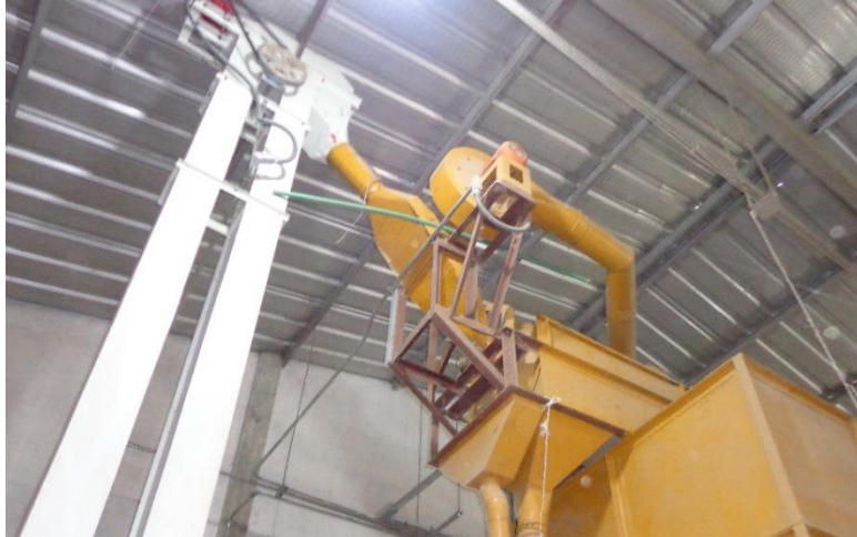
Fig. 3.29 Elevador conectado al ciclón de limpieza para prelimpia.
