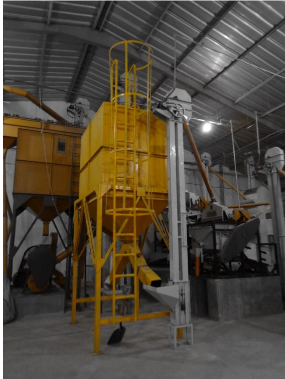
Fig. 4.37 Tolva construida e implementada por MICSA capacidad 3 toneladas
