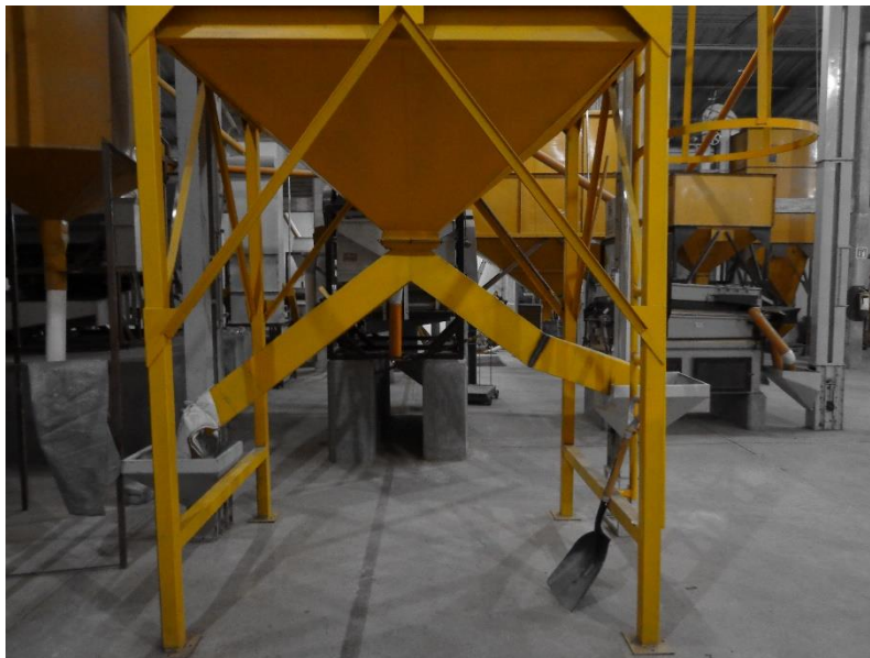
Fig. 4.38 Válvula de dos vías ajustable mediante compuertas.
