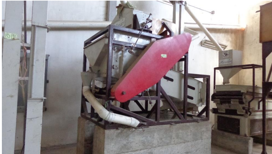
Fig. 3.31 Zaranda equipo para selección de granos por tamaño.
