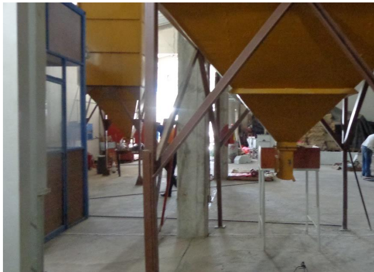
Fig. 3.34 Tolvas de producto terminado, para traslado y estibación del café en almacén para exportación.
