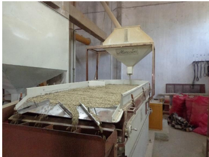
Fig. 3.32 Densimetrica tipo Oliver para selección de granos por peso.
