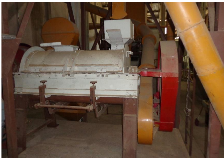
Fig. 3.30 Equipo de trillado de grano pergamino a calidad oro.
