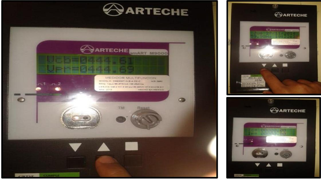
Figura 4.26. Prueba de las Funciones. (Medición de Voltaje, Corriente, frecuencia y potencia)
