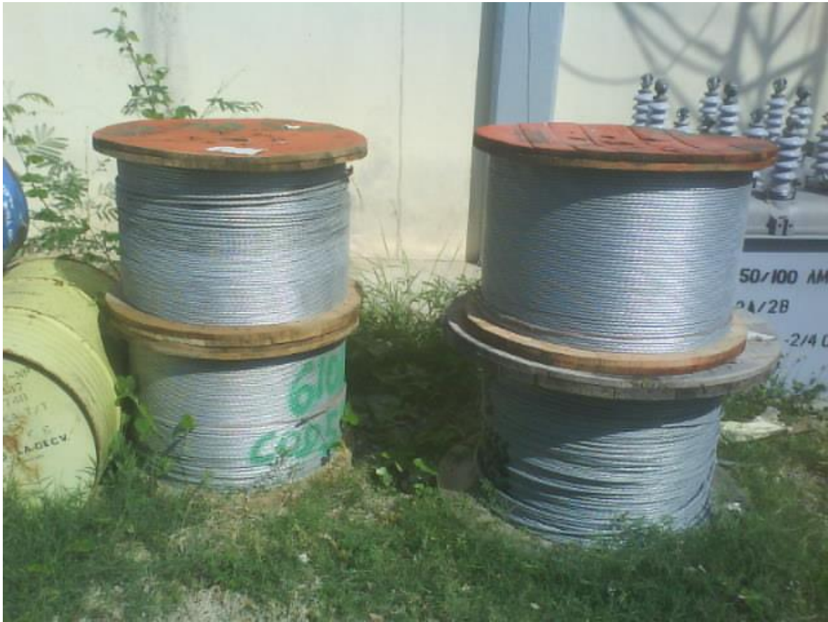
FIG 1.9 CABLE DE ALUMINIO UTILIZADO EN LAS LINEAS DE MEDIA TENSION.
