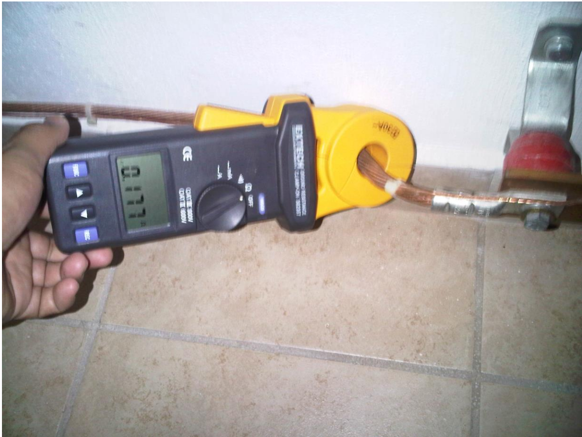
FIG 4.2 EN LA MEDICION DEBE SER NULA PARA EFECTOS DE TIERRA.
