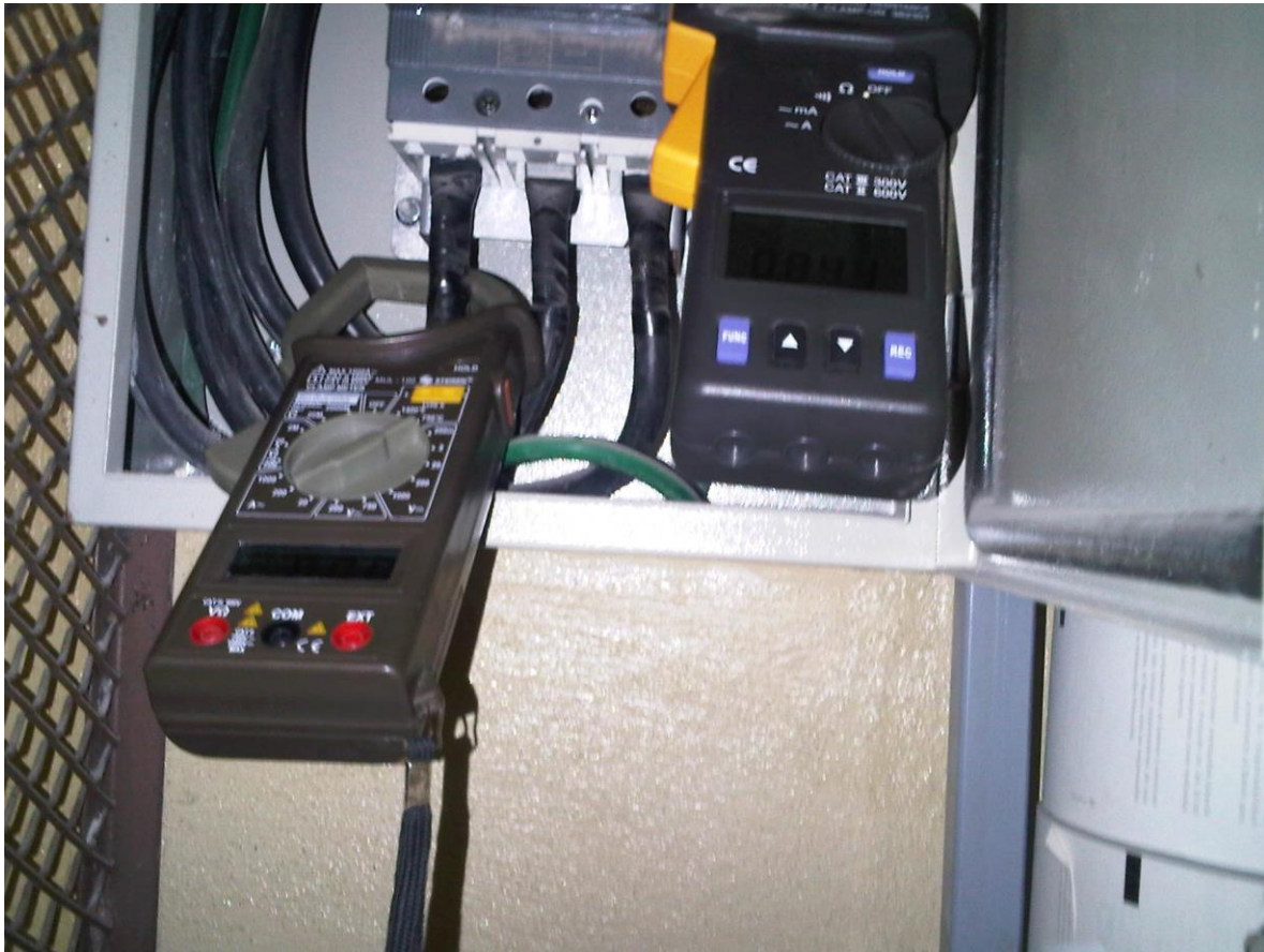
FIG 4.6 RECTIFICANDO MEDICIONES CON OTRO AMPERIMETRO.
